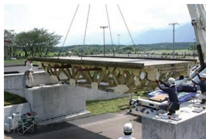
先端的構造材料の実大模型実験
