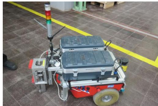
写真-4 BAM の開発した橋梁の非破壊検査装置
