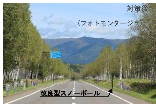
写真-3 固定式視線誘導柱(矢羽根)が改良型スノーポールに変更され、
