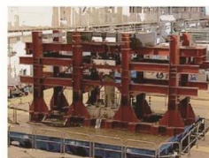
三次元大型振動台装置
