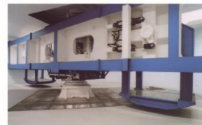
大型動的遠心力載荷試験装置
