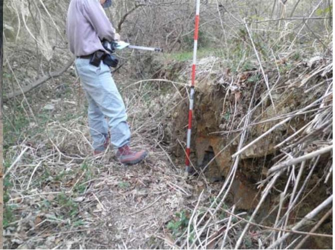
碎石場南側の切り土のり面上部に現れた断層。走向N41W、垂直変位量70cm、開口幅30cm。青灰色の柔らかい粘土は断層粘土の可能性がある。(写真左手の露頭では白色の凝灰岩が観察される。)
