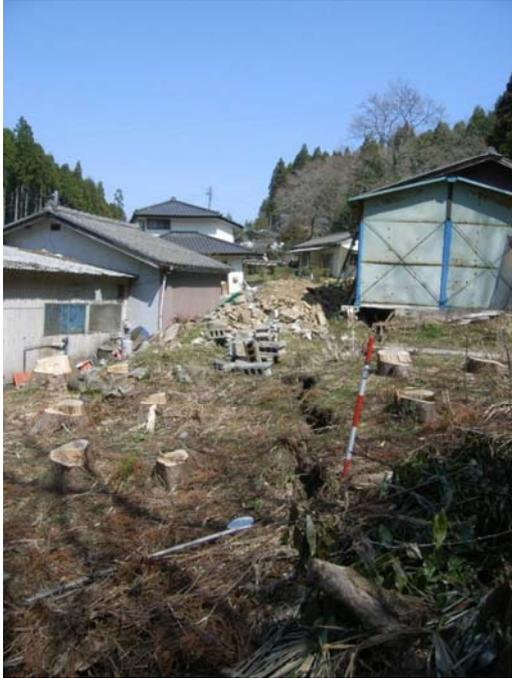
北を望む。断層の走向N5W、垂直変位量西落ち20cm。手前約20mの山地斜面より発する変状は、IdW-3付近まで1km連続することを確認。
