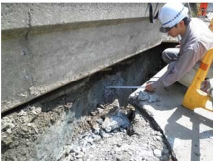
道路横断箇所に見えた断層面。走向傾斜N7W,88E、垂直変位80cm西落ち。青灰色の断層粘土10cm以上。
