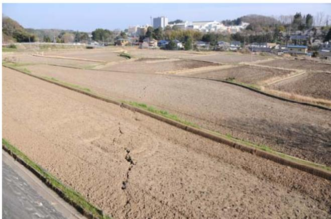
田圃のなかに生じた地割れと段差。地割れはミ型の雁行。写真左側が15-20cm沈下。
