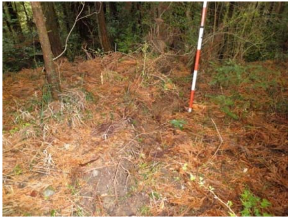
上部の林道に出現した段差。南を望む。走向N7W。垂直変位量20cm程度。
