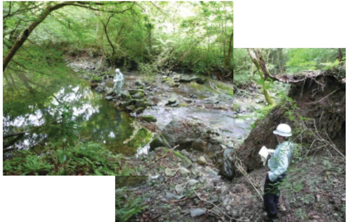
左の写真の下流。北を望む。断層が川を横断し、下流側が高まっている。また、写真右手手前側の山に向かって変位が連続している。河床部での断層面走向N15W、傾斜65W、垂直変位西落ち90cm。
