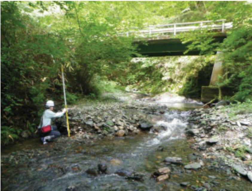
橋の直下流の清道川河床。北を望む。川を横断して変位が発生している。走向N8W、垂直変位西落ち75cm。
