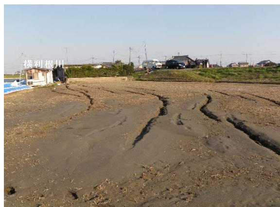
写真-6.74 堤内地の噴砂・地割れの状況
