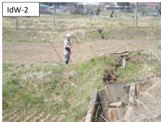
道路横断箇所より北を望む。2条のうちの西側のとう曲。 垂直変位量は約60cm。
