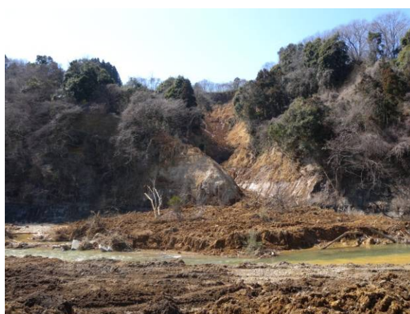
(d) 谷の出口から川を越えて土砂が広がって堆積
