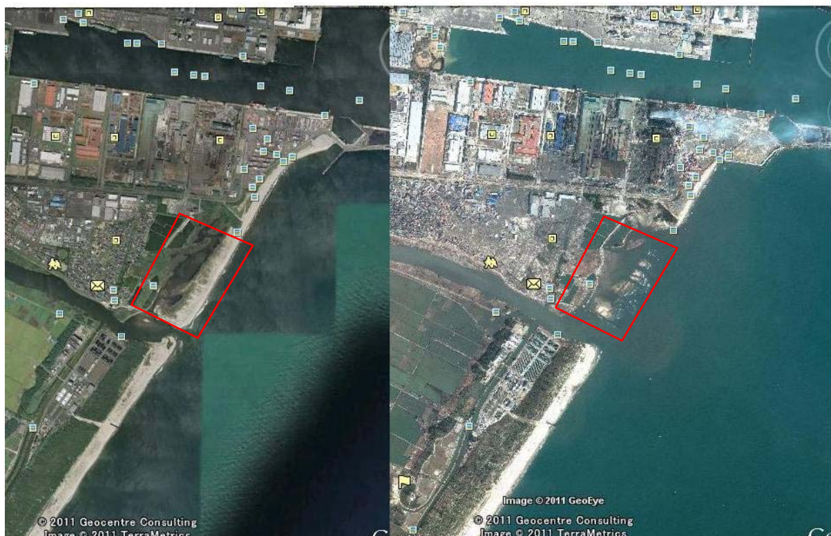
図-5.4.25 七北田川北側干潟前の砂浜消失
