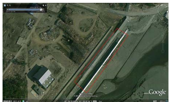
写真-5.4.23 一線堤の被災(裏法被災)
