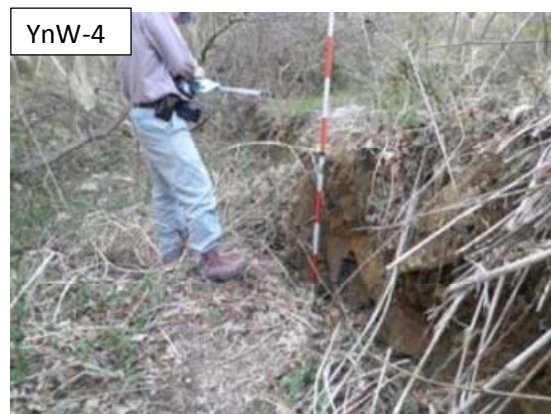
碎石場南側の切り土のり面上部に現れた断層。走向N41W、垂直変位量70cm、開口幅30cm。青灰色の柔らかい粘土は断層粘土の可能性もある。(写真左手の露頭では白色の凝灰岩が観察される。)
