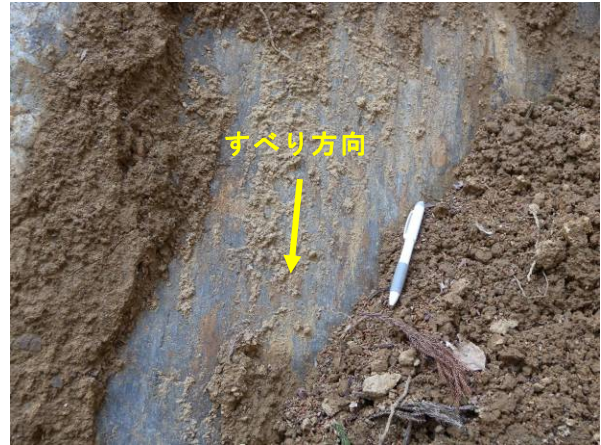
(d) 滑落崖で観察されたすべり面
