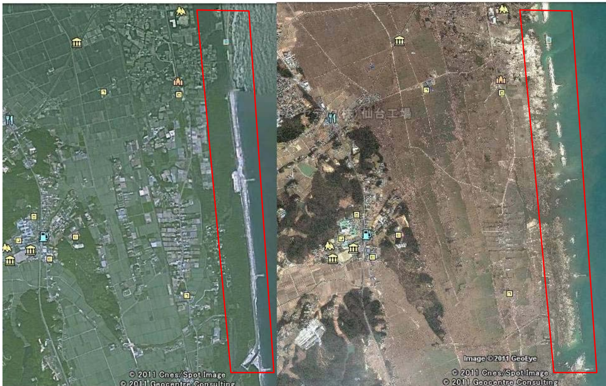
図-5.4.29 破堤・海岸線後退
