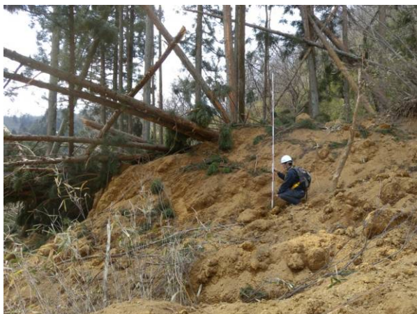
(e) 側部で堤防状に堆積した土砂
