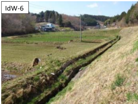
北を望む。西側のトレース。手前より2本目の電柱付近でN29W、とう曲幅約2.5m、垂直変位約70cm、左ずれ20cm。
