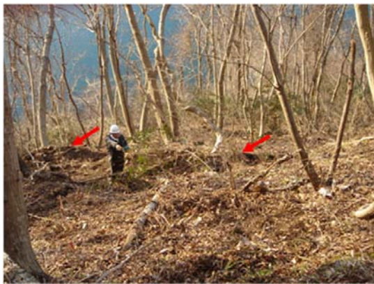
写真-10.36 斜面内に生じた亀裂 (矢印の部分)
