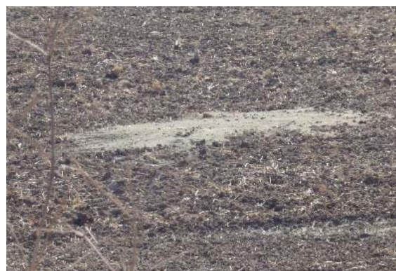
写真-6.92 堤内地側の噴砂痕
