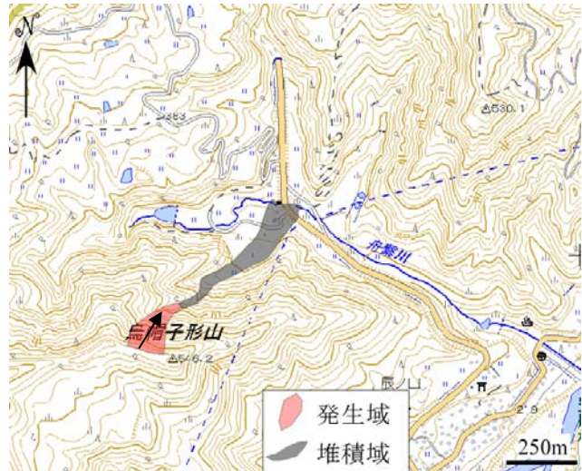
図-4.3.2 新潟県津南町辰口で発生した崩壊 (電子国土の地図に加筆)
