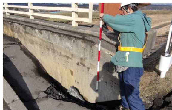
写真-6.36 上谷地橋の橋台アプローチ部に生じた沈下
