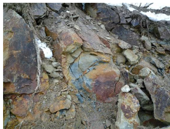
写真-4.3.20 地すべり末端の露頭
