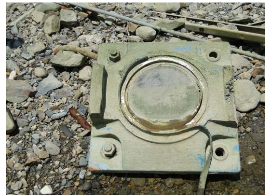
写真-9.117 流出した固定支承の下沓
