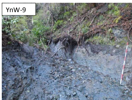
断層面と土砂の流出状況。流出土砂は青灰色の粘土で、断層周辺の破碎粘土であると考えられる。断層変位は断層粘土と壁岩の境界付近 (写真のポールがある面) で発生した。露頭脇の道路面の変位量(15cm)に比べて壁岩の露出が多いのは、壁岩に張り付いている断層粘土が崩落、あるいは浸食されたためと考えられる。
