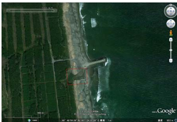
写真-5.4.12 引き波によると思われる排水路の流路拡大跡
