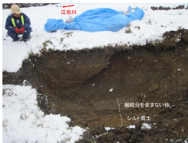
写真-6.50 トレンチ掘削状況(江合橋上流側の天端)
