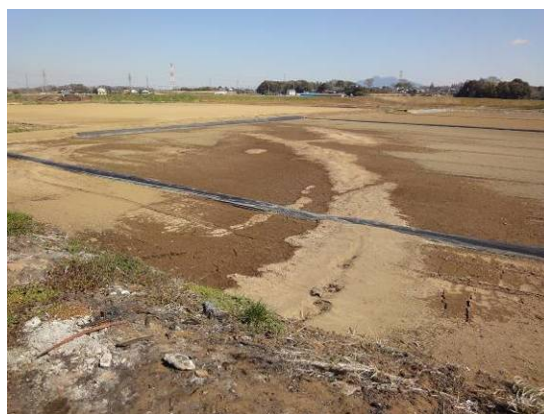
写真-6.83 堤内地の噴砂痕
