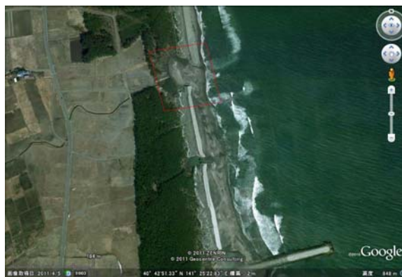
写真-5.4.13 施工端、排水路周辺の引き波によると思われる流路拡大跡
