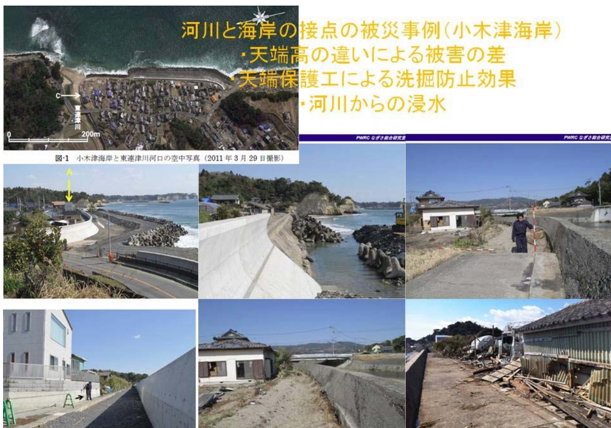
写真-5. 4. 128 河川からの浸水・洗掘（小木津海岸）
