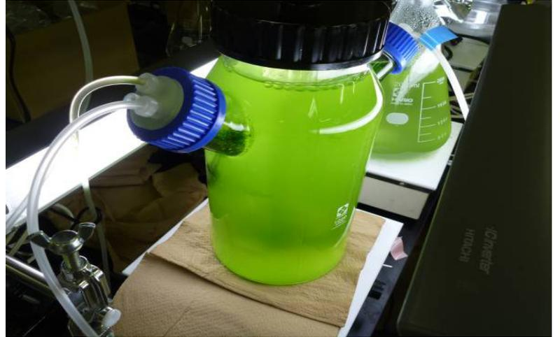
下水処理水による藻類の連続培養試験
