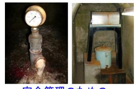
安全管理のための計測器の故障・劣化
