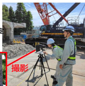
図3 切断面の鋼材腐食調査
