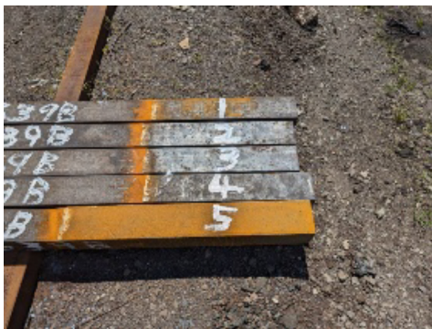
図2 Cr, Siの添加による局部腐食発生の抑制
