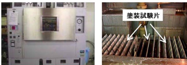
図4 複合サイクル試験機によるサイクル腐食試験
