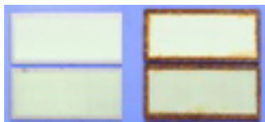
図2 【耐環境試験】防錆と発光効果を確認(左)試験前、(右)試験後
