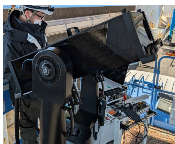
図1 ダブルパルスLIBS装置
