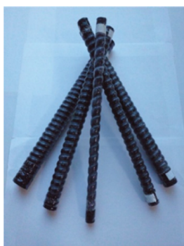
図2 ロッド開発 (太径・異形)
