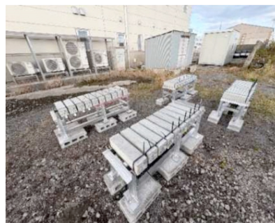
図3 伊藤製鐵所石巻工場の敷地内においてコンクリート試験体の暴露試験開始
