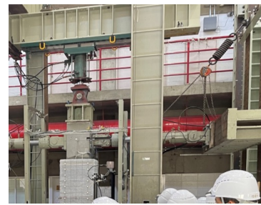
図3 3DCP埋設型枠とバサルトFRPロッドを用いたRC柱の公開実験の様子
