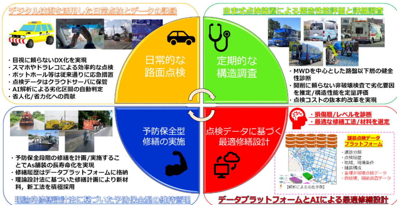
図1 本研究で目指す舗装のマネジメントサイクル(High intelligence Pavement Management System)
