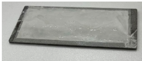
図3 【フッ素樹脂上への防錆コーティング】フッ素樹脂コーティング面への上塗り塗装に成功
