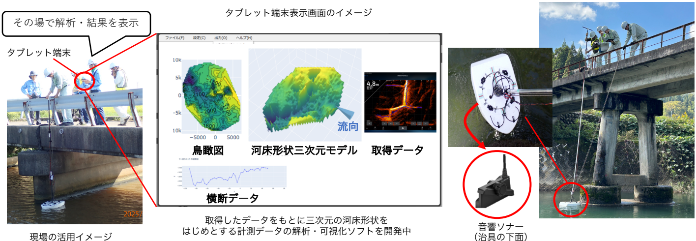
図1 河床形状の三次元モデルでの可視化
