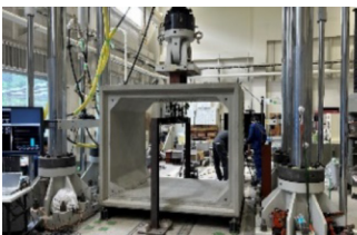
図3 模擬劣化を有する実寸大の短支間橋を用いた載荷試験
