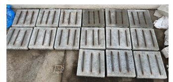
図4 DIY技術の効果確認に資する暴露実験
