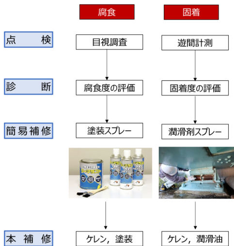
図4 鋼製支承の手引きの構成
