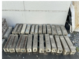
図2 鉄筋腐食に対するDIYに資する暴露実験
