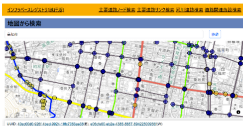
図2 道路リンク、道路施設、河川等のベースレジストリのプロトタイプを公開
