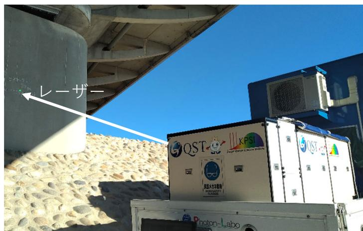
レーザー打音検査装置
