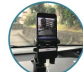
車載スマートフォンで AIによる路面損傷検知
