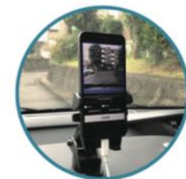
車載スマートフォンで AIによる路面損傷検知
