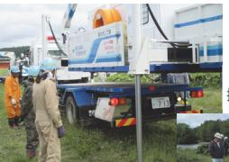
排水ポンプ設置支援ユニット(制御盤)
