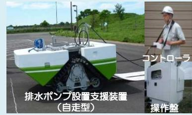
近年、大規模な地震やゲリラ豪雨などの異常気象により、津波や天然ダムなどの災害が発生しています。また、積雪寒冷地においては冬の降雨による出水も発生しています。このような災害時の排水作業においては、軟弱地盤、不整地、積雪などの現地条件によって、排水ポンプ車の搬入および排水ポンプの設置が困難となり、迅速な作業に支障を来しています。さらに、作業員の高齢化が進んでおり、排水ポンプの運搬や設置、回収などの作業の軽減が求められています。
