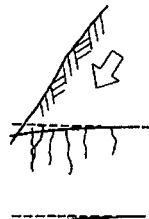
(c) 坑口部の不同沈下
