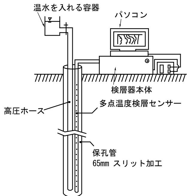
図2-3-3 多点温度検層装置概要図<sup>19)</sup>
