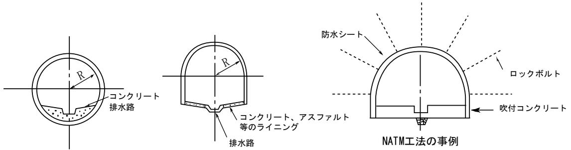
図5-17 排水トンネルの断面形状の事例
