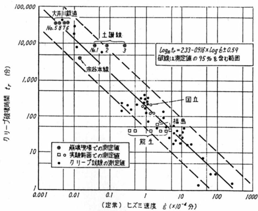
図 4-12 斜面崩壊の実測結果<sup>2)</sup>
