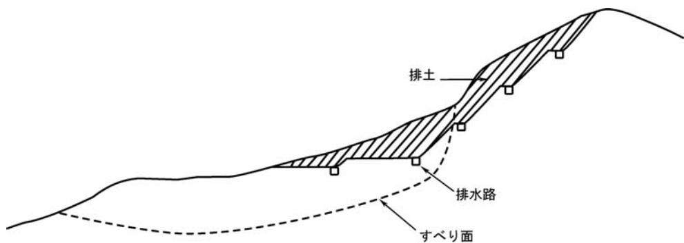
図5-18 排土工と切土のり面
