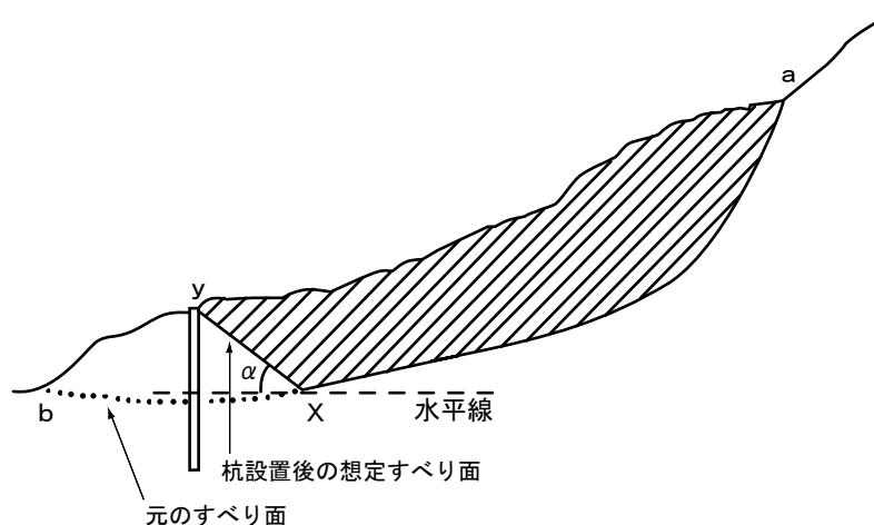
図 5-21 杭の上部の受動破壊<sup>1)</sup>
