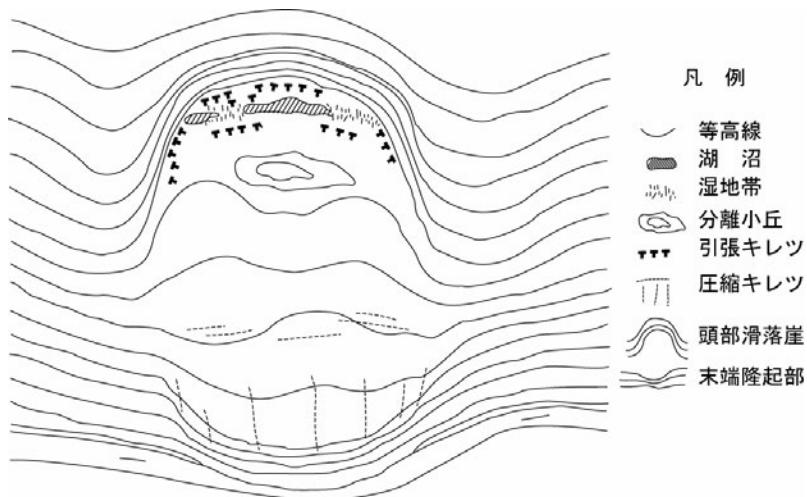
図2-2 地すべり地形模式図<sup>2)</sup>
