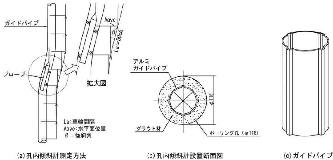
図2-10 挿入型孔内傾斜計の概要図<sup>10)</sup>に加筆
