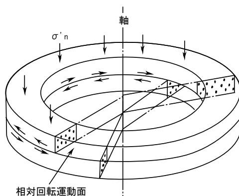
図2-35 リングせん断試験器<sup>21)</sup>
