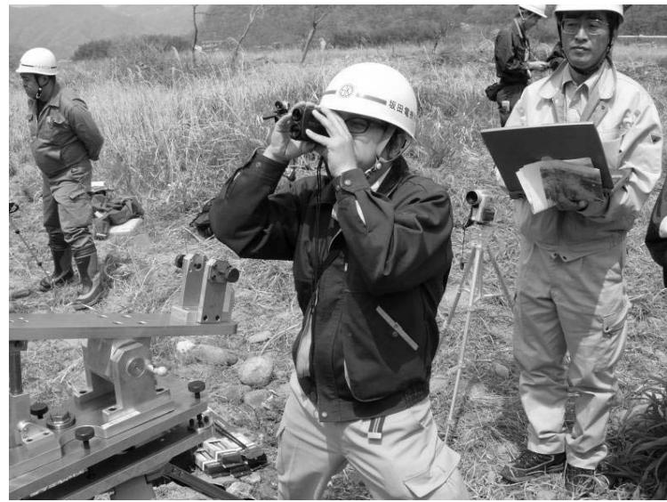
写真参ー7 レーザー距離計による斜距離の計測
