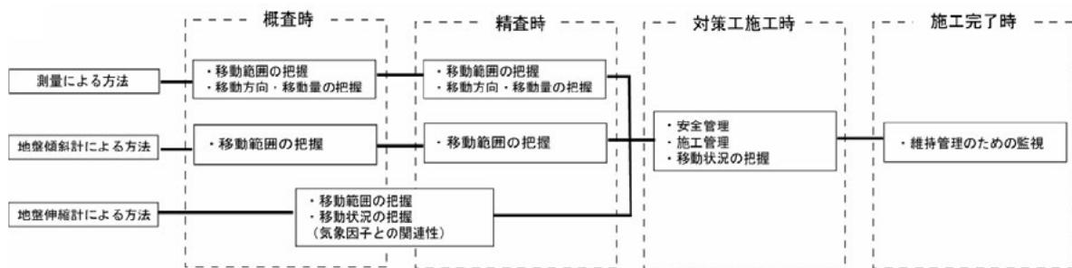
図2-17 地表変動調査の目的と方法
