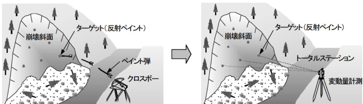
図4-2 ターゲットの遠隔設置による計測手法「RE・MO・TE<sup>2</sup>」の概要
