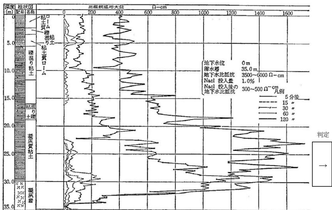
図 2-32 地下水検層測定結果<sup>2)</sup>
