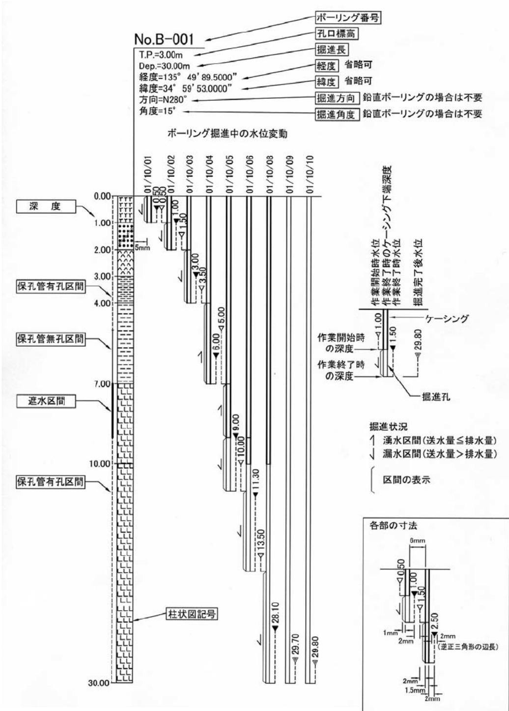
図2-30 ボーリング掘進中の水位変動の記載例<sup>6)</sup>を一部修正
