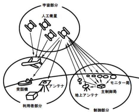
図2-23 GPS測量概念図<sup>1,3)</sup>
