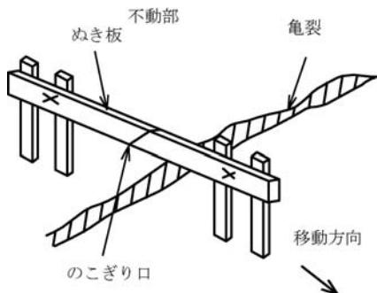
図4-3 ぬき板による計測例<sup>1)</sup>
