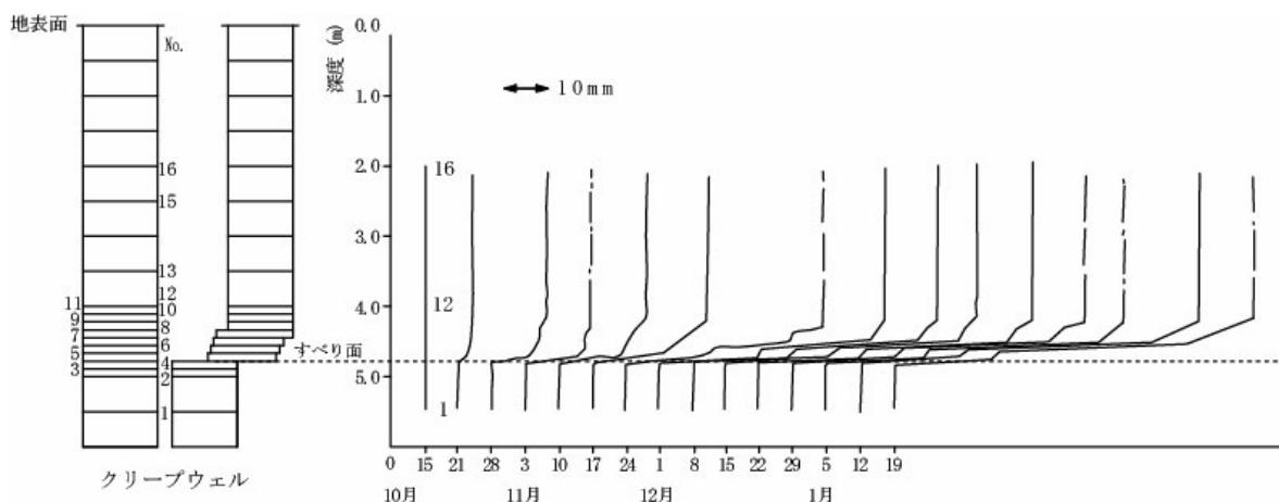
図 2-16 クリープウェルの概要図<sup>10)</sup>
