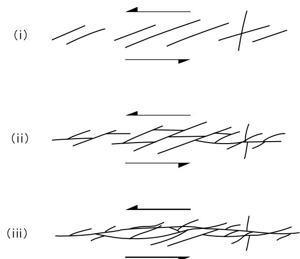
図参ー9 すべり面の発達過程<sup>9)</sup> の一部を修正
