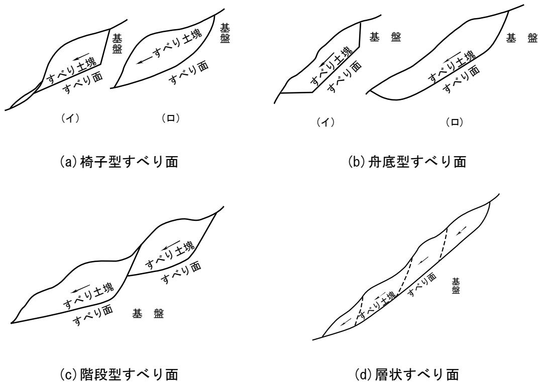
図参-7 すべり面形状の模式図<sup>6)</sup>
