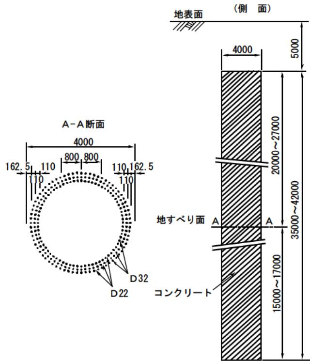
図 5-22 シャフト工の例 (単位 : mm)
