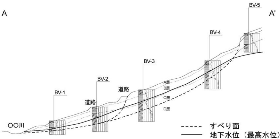
図2-37 主測線地質断面図の一例
