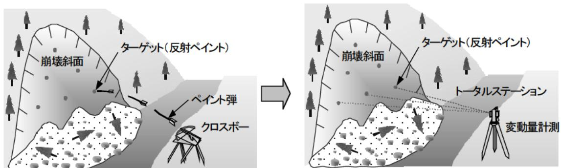
図参ー11 「RE・MO・TE<sup>2</sup>」の概要<sup>12)</sup>
