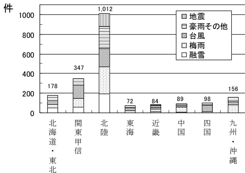
図参-3 H 7～16 の誘因別地すべり発生件数<sup>3)</sup> の一部を修正加筆
