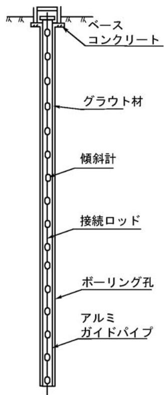
図2-12 設置型孔内傾斜計の設置全体図<sup>10)</sup> を一部修正
