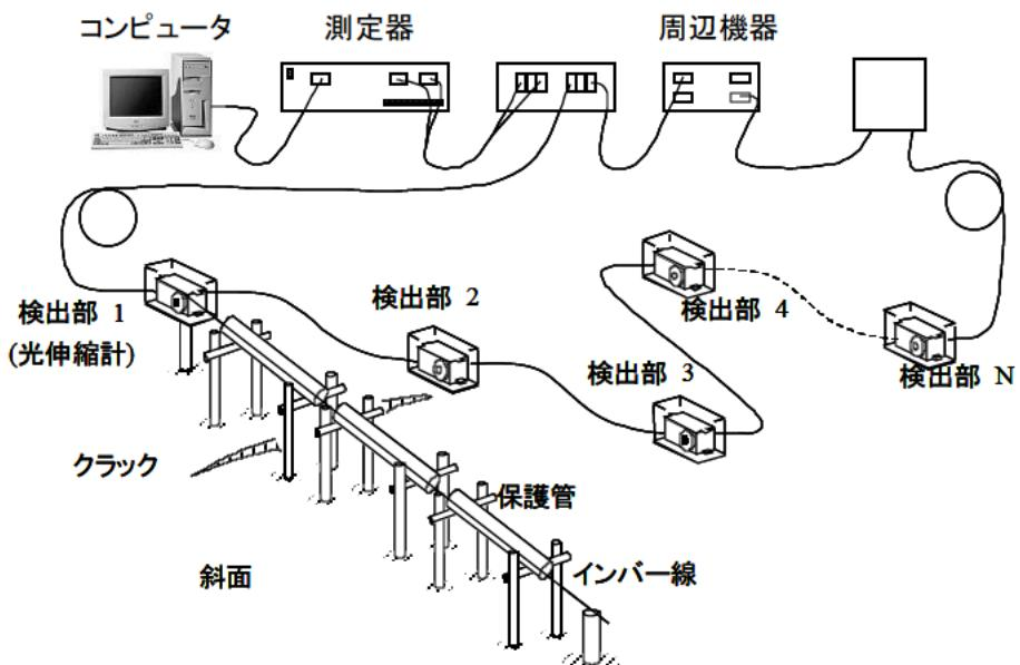
図2-24 光ファイバーを活用した地盤変位計による観測<sup>15)</sup>
