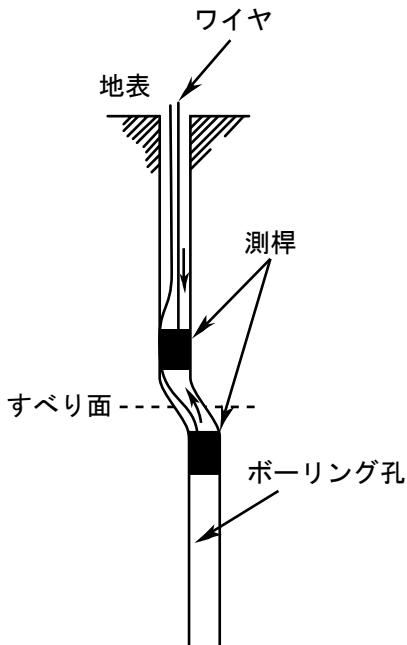
図2-8 すべり面測桿によるすべり面の判定<sup>8)</sup> を一部修正
