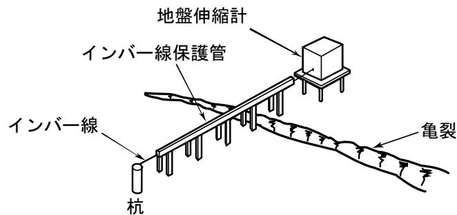
図 2-18 地盤伸縮計設置概略図<sup>1)</sup>
