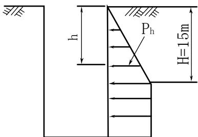
図5-15 集水井外周面に作用する土圧
