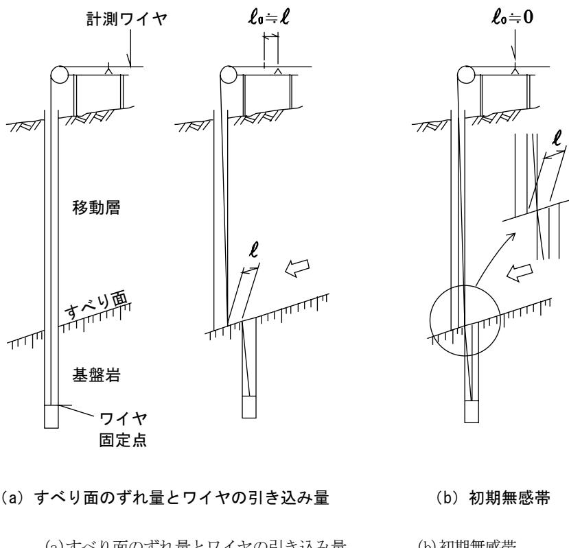
図2-13 縦型伸縮計の概要図<sup>10)</sup>
