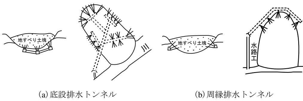
図5-16 排水トンネル工
