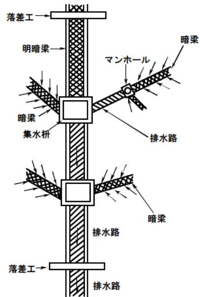
図 5-8 集水した地下水の処理
