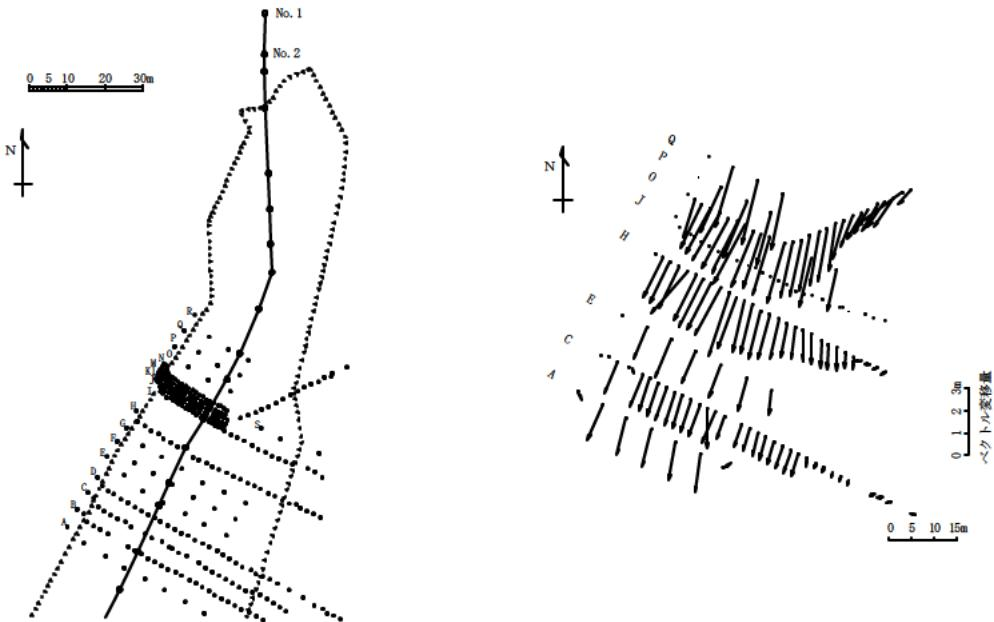
図2-22 移動杭測定結果<sup>1)</sup>
