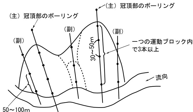
図2-5 ブロック毎の測線沿いのボーリングの配置<sup>4)</sup> を一部修正
