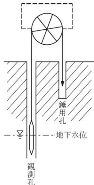
図2-26 フロート式水位計<sup>13)</sup>
