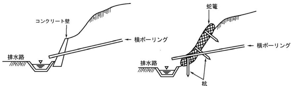
図 5－11 横ボーリング孔口保護工
