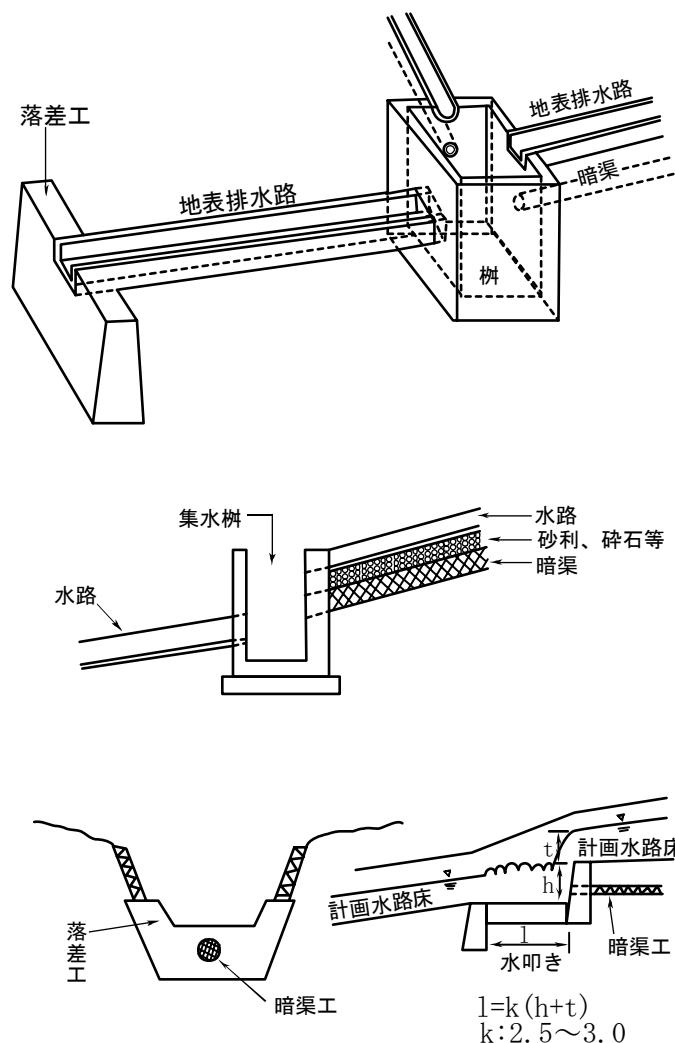
図5-4 集水桿と落差工標準図
