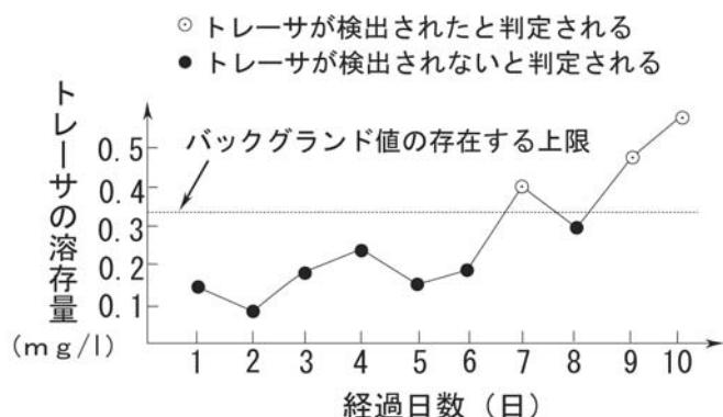
図2-34 トレーサの検出結果図<sup>1)</sup>
