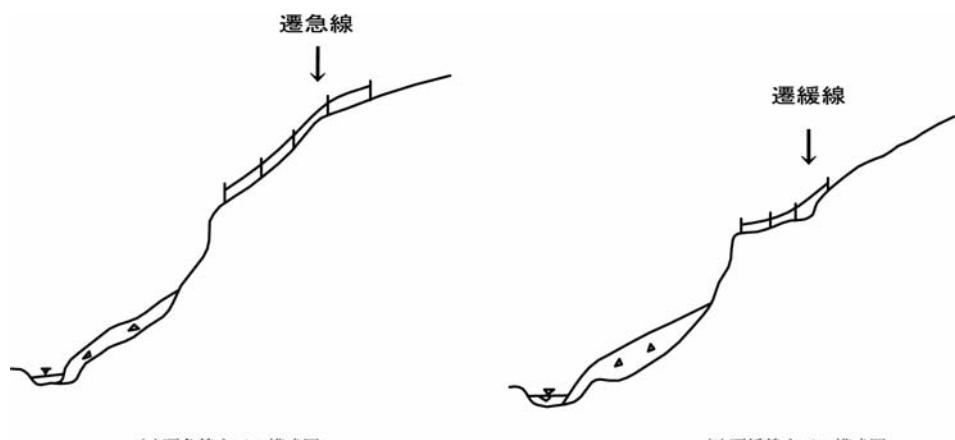
図4-1 地盤伸縮計の設置範囲<sup>1)</sup>
