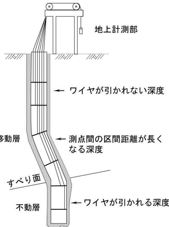
図2－14 多層移動量計の概要図<sup>11)</sup>
