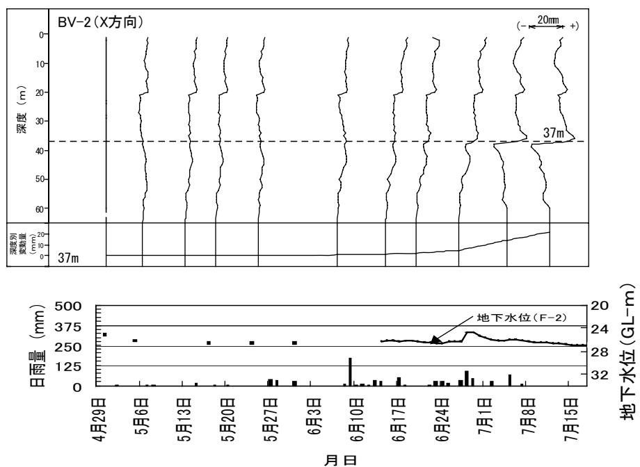
図2-11 孔内傾斜計による変動累積図の例
