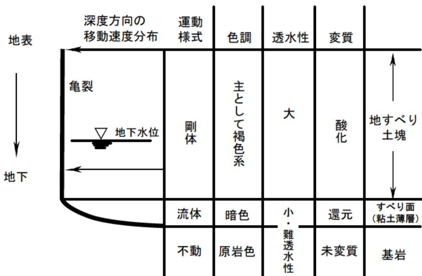
図2-7 地すべり斜面の構成<sup>8)</sup>を一部修正
