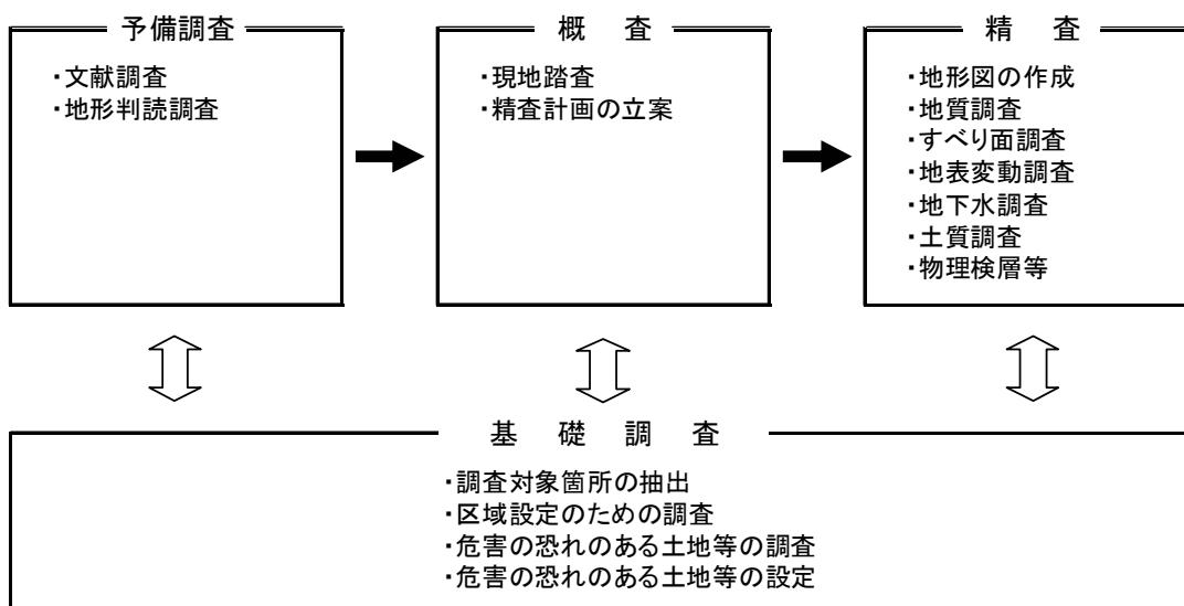
図2-1 地すべり調査の概要<sup>1)</sup>に加筆
