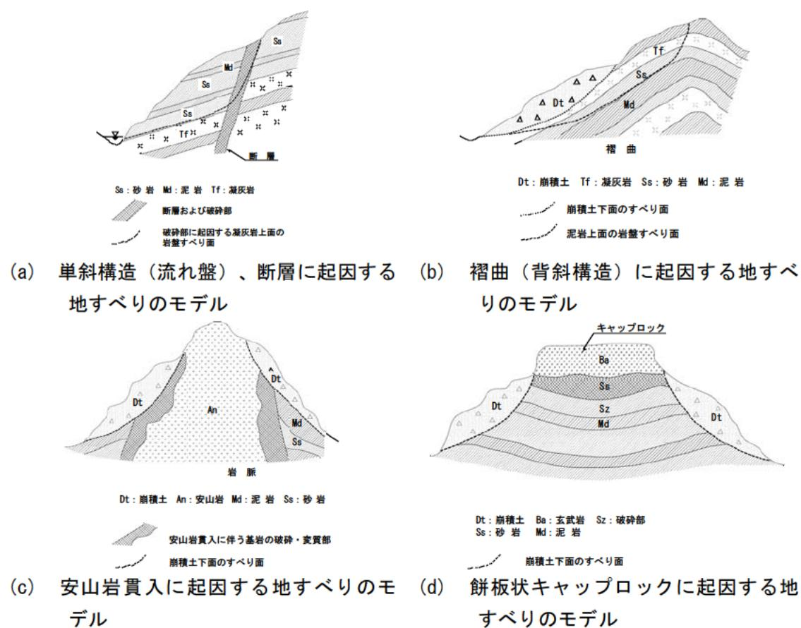
図参－2 地質構造に起因する地すべりのモデル<sup>2)</sup>
