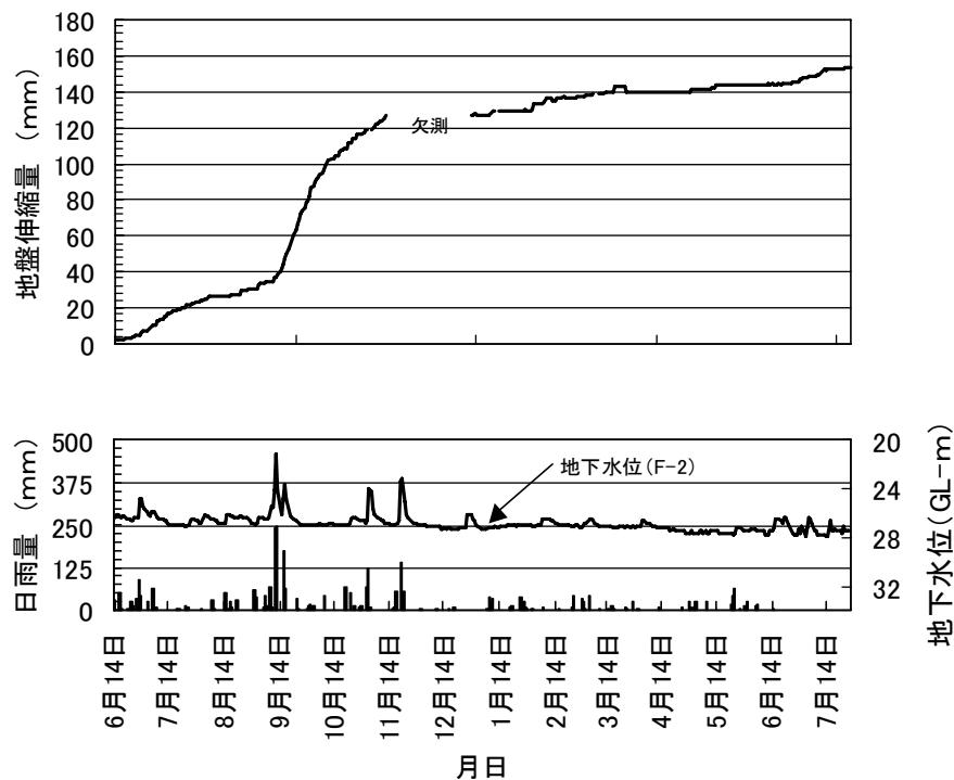
図 2-19 地盤伸縮計測定結果の整理例
