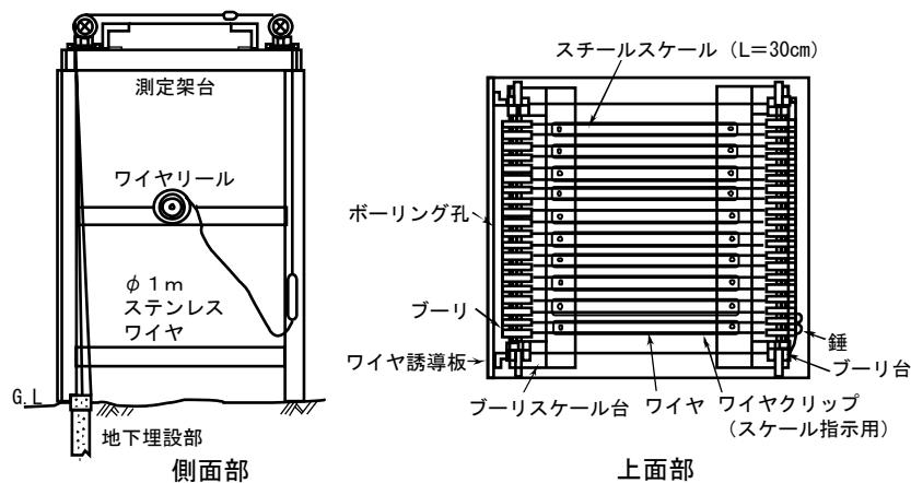
図2－15 多層移動量計計測部<sup>11)</sup>
