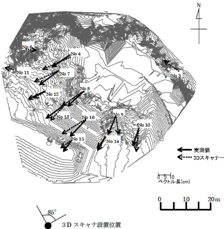
図2-25 レーザースキャナによる移動量測定例<sup>16)</sup>
