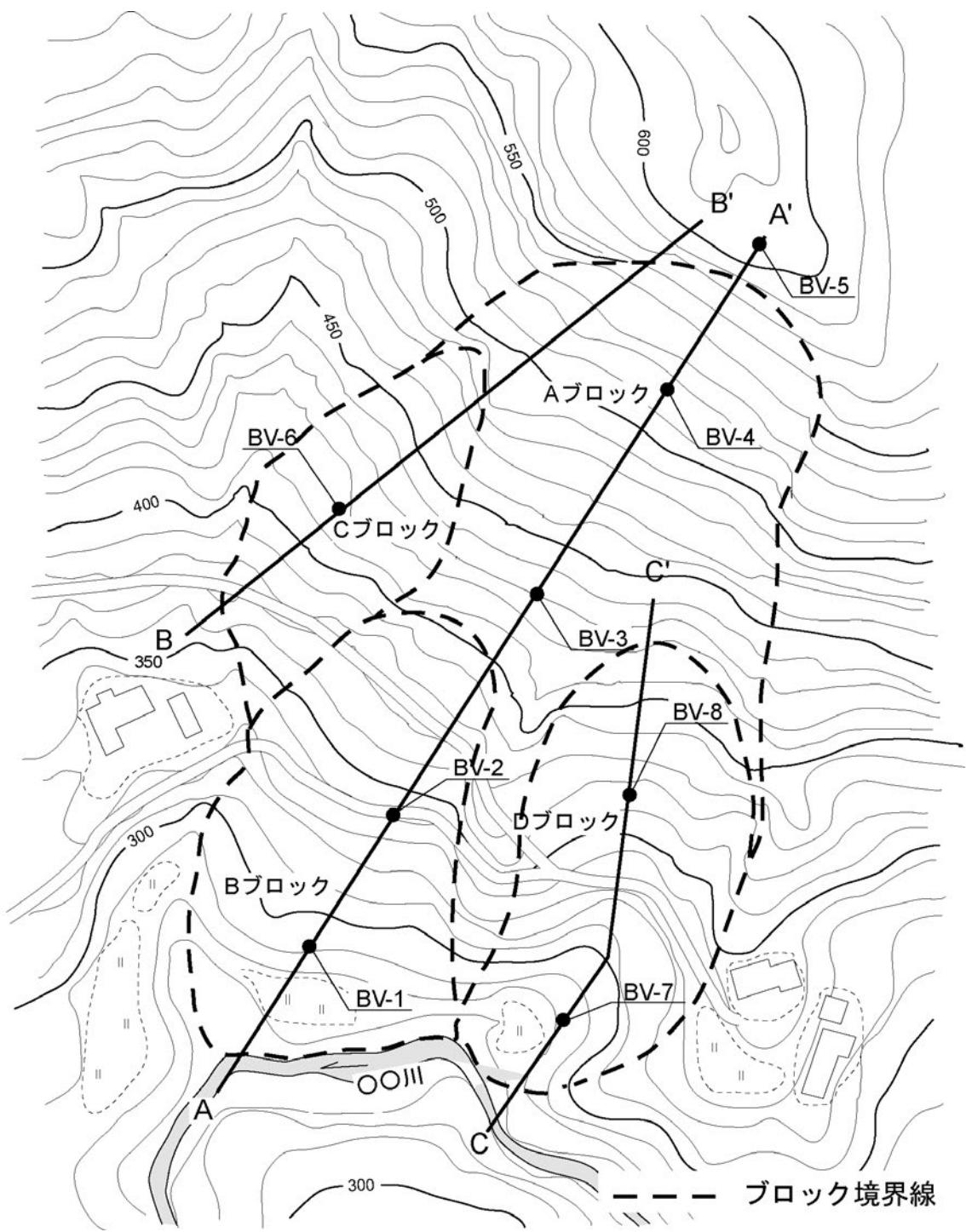
図2-36 地すべり運動ブロック図の例
