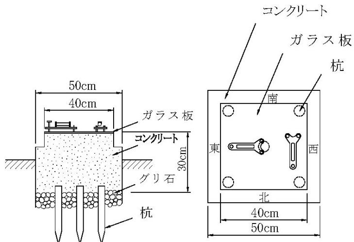
図2-20 地盤傾斜計設置例<sup>1,2)</sup>に加筆
