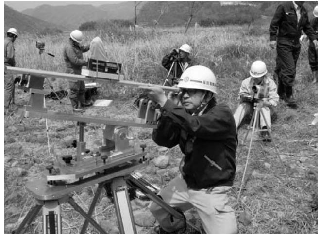
写真参－6 角度計による計測状況
