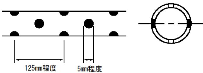
図5-12 集水管のストレーナの例
