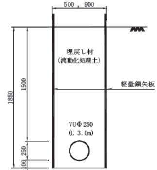
図4.1 埋戻しモデル
