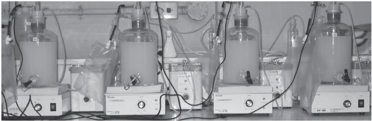
図-3 実験に用いた反応装置(ガラス容器、スターラー、pH制御)
