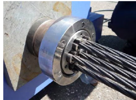
ジョイントスリーブとクサビが緩んだ状態
