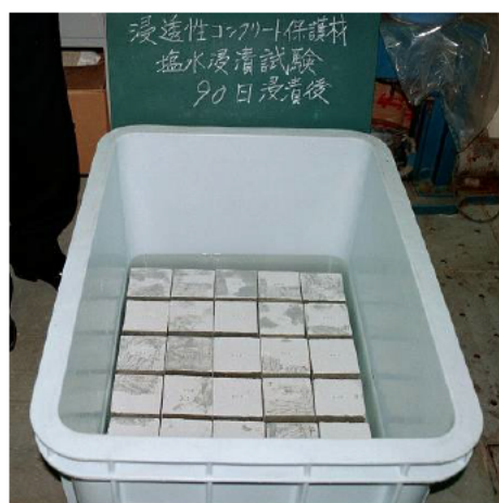
図－Ⅲ.1.8 塩化物イオン浸透性試験方法
