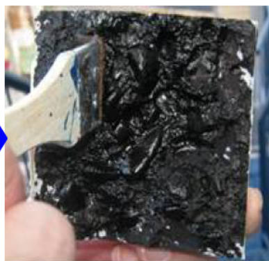
図－Ⅲ.2.6 墨汁法による浸透深さの測定フロー
