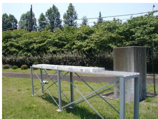
写真－Ⅲ.1.5 つくば暴露試験状況
