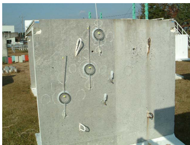
写真－Ⅳ. 1. 1 現場透水試験器具の試験状況
