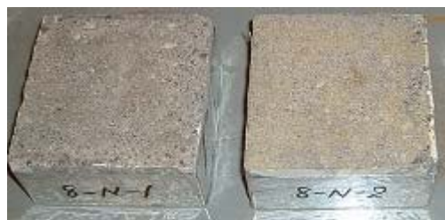
付属写真－6.2 シール後の試験体
