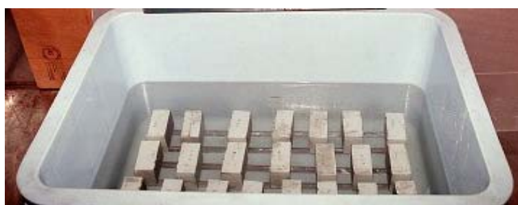
写真－Ⅲ.1.2 試験体の浸漬状況
