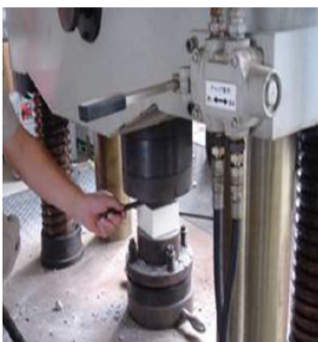
図－Ⅲ.2.6 墨汁法による浸透深さの測定フロー
