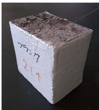
写真－Ⅲ. 1. 14 シール後の試験体
