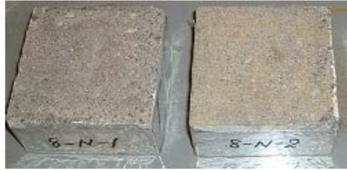
写真－Ⅲ.1.3 シール後の試験体例
