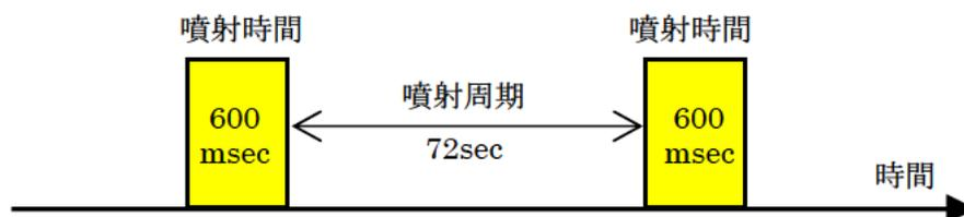
図 1.2.19 原料の噴射パターン
