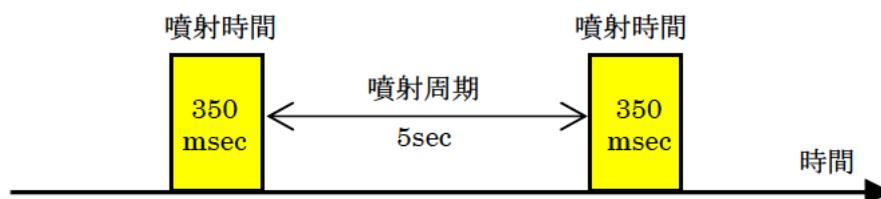
図 1.2.17 原料の噴射パターン
