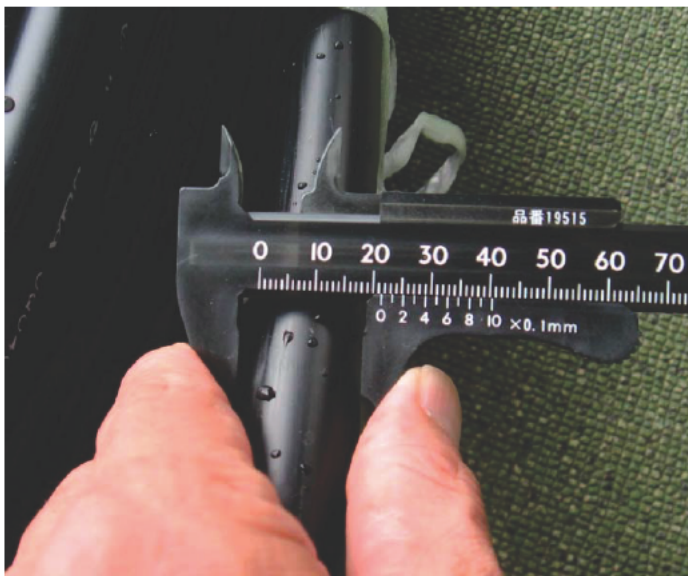
写真3-11 丸形ホースの外径 (約 22mm)
