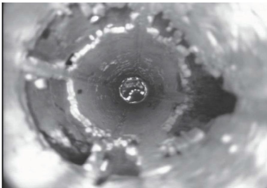
写真4-2 ガイド管破損例（カメラ観察による）
