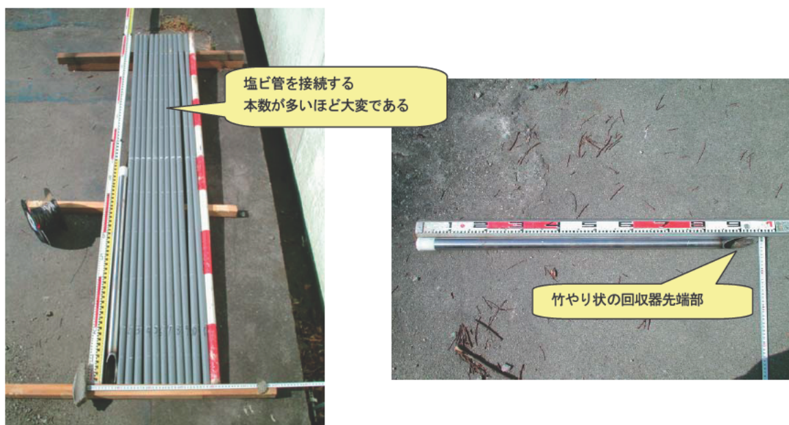
写真4-1 孔内傾斜計プローブ回収器
