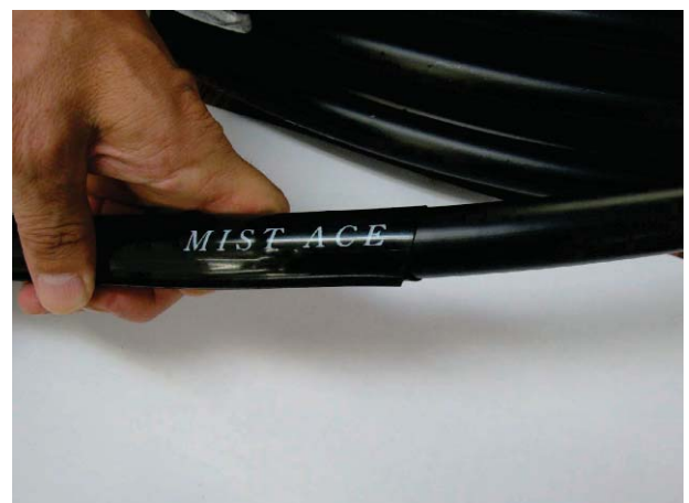
写真3-16 平形ホースを丸形ホースに被せたところ
