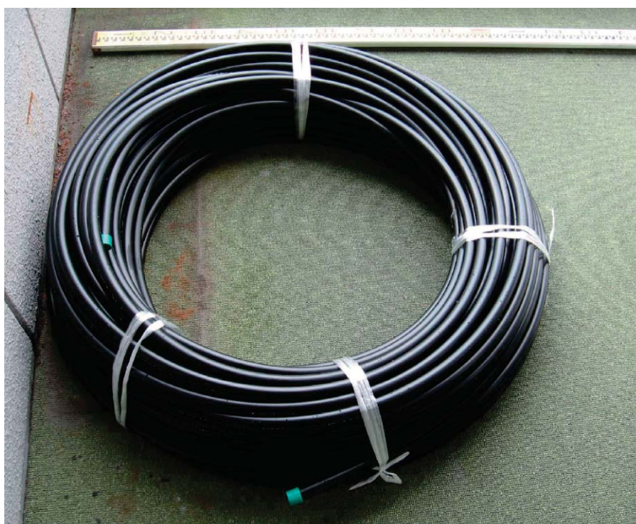
写真3-4 一般的な丸形グラウトホースの例
