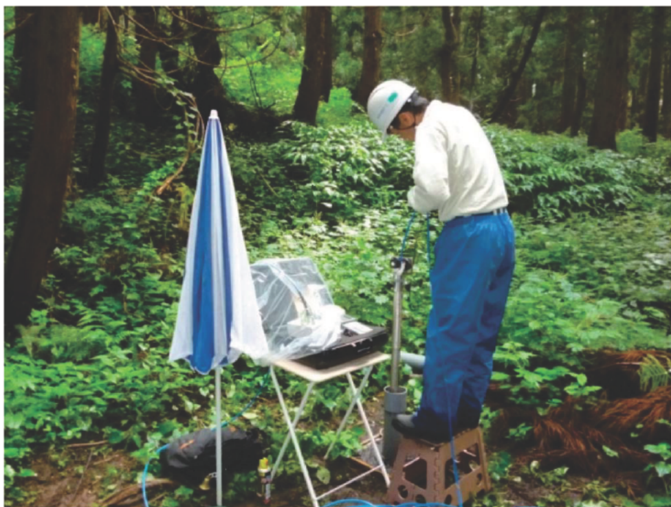
写真4-6 測定器にビニール袋をかぶせて不意の降雨に備える
