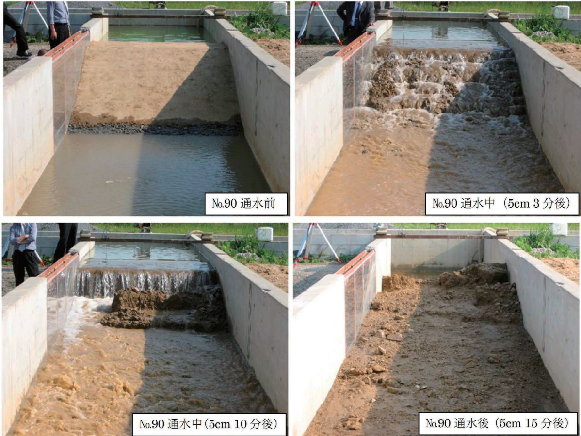
写真-2.29 小型模型実験の状況 (ケース90、堤体内ミズミチ有り、堤体・基盤：高締固め度)
