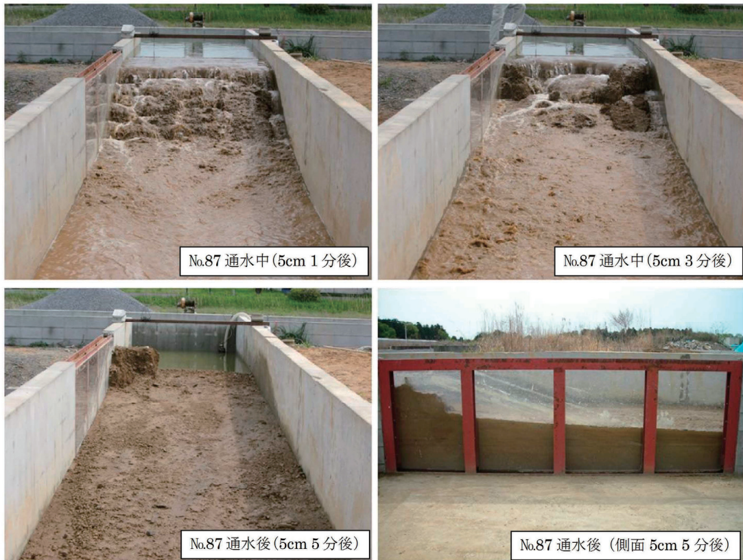
写真-2.26 小型模型実験の状況（ケース87、堤体・基盤：低締固め度）
