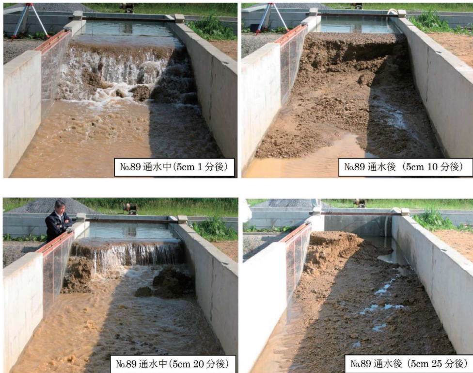
写真-2.28 小型模型実験の状況（ケース.89、堤防天端&裏のり面：高締固め度）
