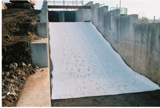
写真-2.3 完成形（越水直前の堤防模型）
