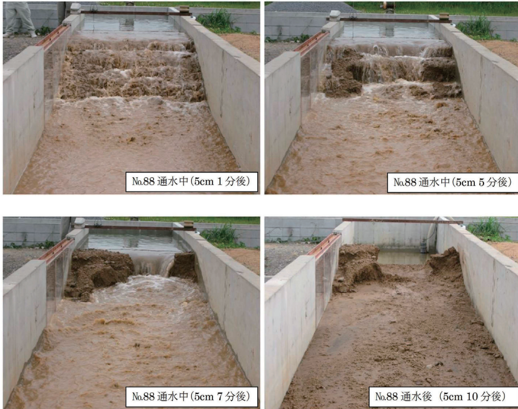
写真-2.27 小型模型実験の状況（ケース88、堤体：低締固め度、基盤：高締固め度）
