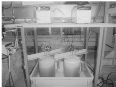
図 2-1 電気分解試験装置
