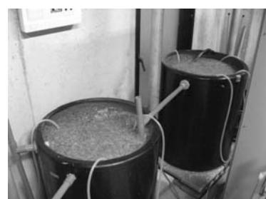
写真-4 担体処理反応槽
