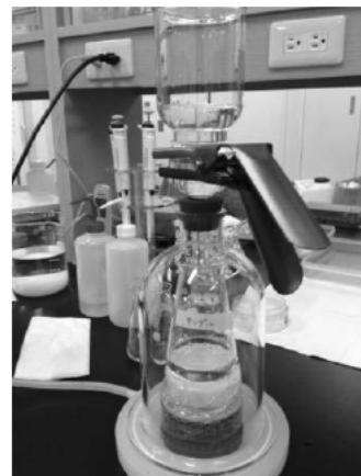
図2 吸引ろ過装置の外観図
