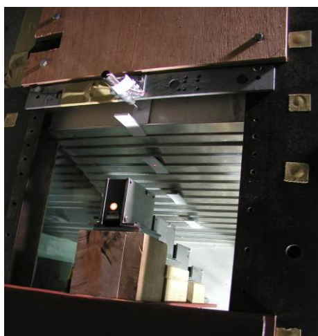
図 2-31 変位計の設置
