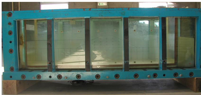
図 2-2 動的大型土槽
