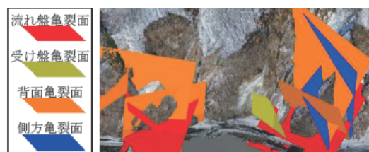
図-7 開口亀裂面の三次元モデル化 11)
