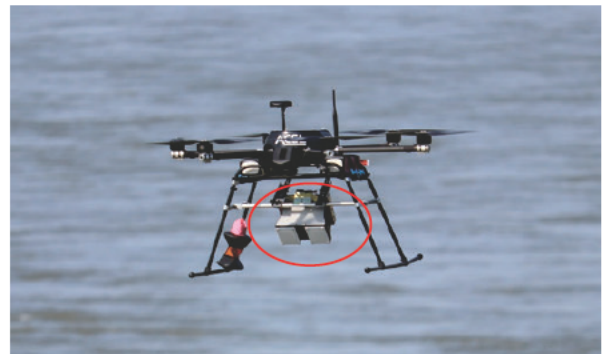
写真－５ ドローンに搭載した電波式流速計
