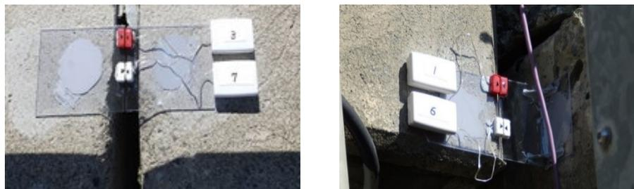
図 6.6.7 センサ設置状況 (桁端部)
