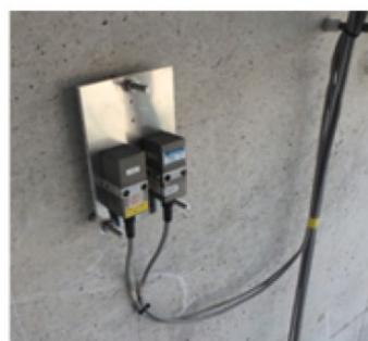
図 6.2.5 加速度計の設置状況<sup>1)</sup>
