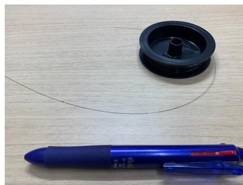
図 3.1.7 光ファイバの例 (0.25mm 素線)
