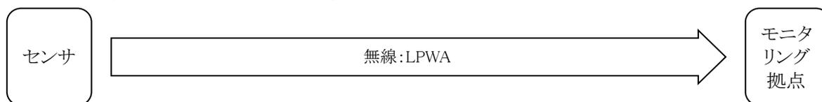
LPWA データ通信サービスを契約し、LPWA インタフェースを内蔵したセンサから直接データを送る方式。一般に LPWA データ通信サービスは端末 1 台当たり 1 契約が必要で、契約する端末数と 1 日あたりの通信回数によりサービス費用が大きく異なる。多くのセンサを契約し低頻度で計測する場合は低コストでデータ収集できる。また、センサ端末を電池で長期間動作させる事ができる無線方式のため、配線が不要のメリットがある。通信距離は数キロから数十キロと長距離の到達性が特徴だが、距離を延ばすためには伝送速度を下げることがあり、1 回に通信できるデータ量が少なくなるため、大量のデータを発生するセンサには向かない。また通信事業者のサービスエリア内で利用する必要があり、またビル影などで電波状態が悪い場所では通信できない場合があるため、現時点では利用できる場所が限られているため、道路の様に長い区間にセンサを配備する用途には向かない場合がある。また、現時点で LPWA 対応のインフラモニタリング向けセンサはほとんど市販されていないため、必要なセンサに LPWA 対応させるための開発が必要となる。
