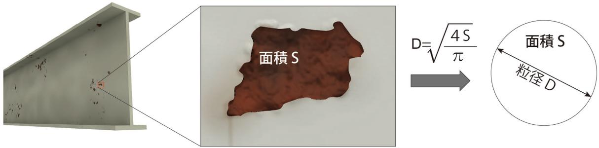
図 7.3.2 個々の劣化部面積から粒径を計算するイメージ
