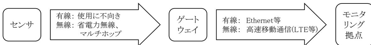
のり面・斜面にセンサを設置し，傾斜等を一定間隔で計測し，路側に設置されたゲートウェイからデータをモニタリング拠点に伝送集約するシステムである。このシステムの特徴は，モニタリング状況によりデータ計測頻度を変更するシステムもあるため，通常時のデータ伝送量のみならず，異常時のデータ伝送量を考慮したシステム設計が必要となる。当然路側のゲートウェイから，モニタリング拠点間のデータ伝送には LPWA のような通信速度の遅い伝送システムは不向きである。
