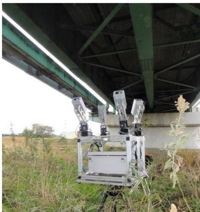
図 2.1.6 標定点照射装置の例
