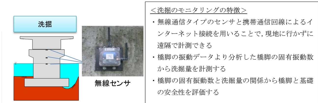
図 4.1.1 洗掘のモニタリングの特徴
