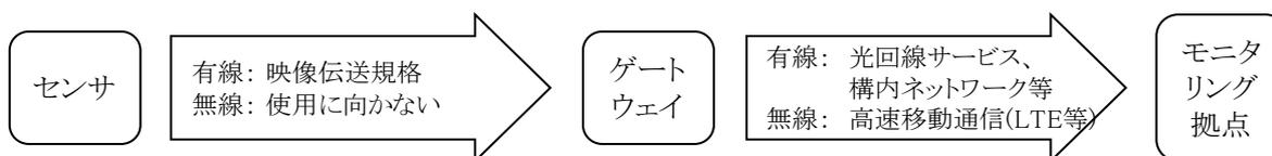
ひび割れを遠隔で目視監視する場合には、現場に設置した監視カメラ等から事務所（モニタリング拠点）まで映像データの伝送が必要となる。映像伝送には高速大容量（フル HD の場合で 13Mbps 程度）の通信回線が必要のため、IoT 向けの低速の省電力無線では対応できない。このため、IAN には映像伝送規格の有線接続などを用い、WAN には LTE などの高速移動体通信サービス、光回線サービス、または道路管理者の構内ネットワーク等でデータを伝送する必要がある。
