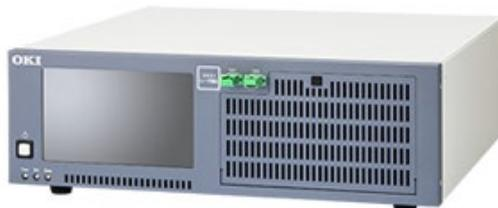
(付録)図 3 SDH-BOTDR 計測器の例
