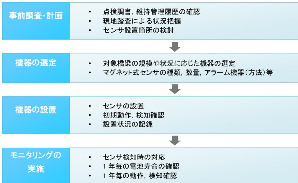
図 5.2.1 桁端部の異常検知モニタリングの手順例
