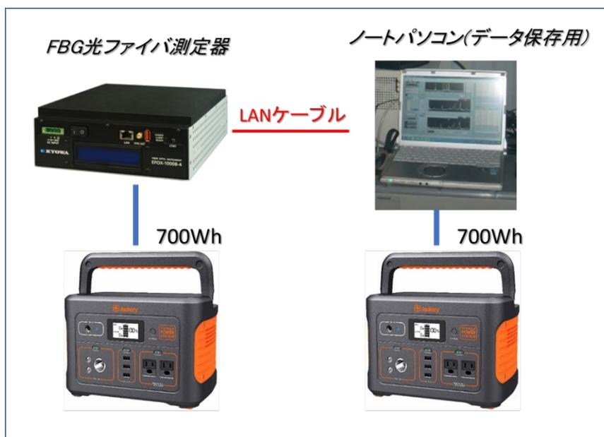
図 6.8.13 測定システムの構成例
