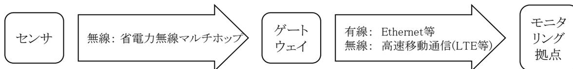
定点収集型モニタリングとは、現場のインフラ構造物等に設置したセンサから集めた計測データを、広域ネットワークなどを経由して事務所やデータセンタに設置されたサーバへ継続的に送る方法である。この方法は現場に行かずに定常的にデータを収集できる点が特徴である。センサを現場に固定的に設置するため、長期間の電池駆動ができる省電力無線センサを利用すると、通信線路や電源が不要でモニタリング設備のメンテナンスが容易となる。
