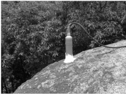
図 6.1.2 速度型 3 成分振動計
