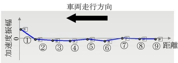
図 7.4.8 上り線の振動形状(93Hz)
