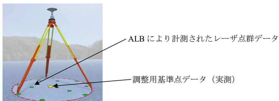
図 2.2.3 調整用基準点観測 (実測) とレーザ計測点群の比較イメージ
