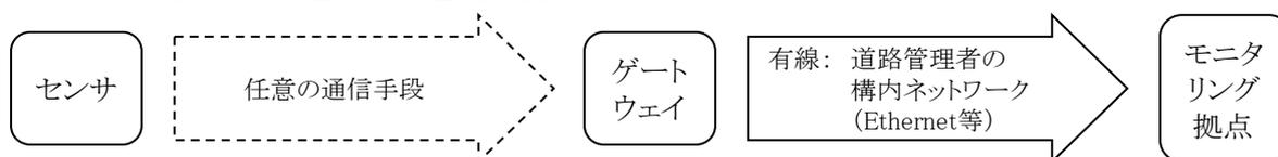
現場で道路管理者の構内ネットワークなどへ接続ができる場合には、計測器やデータロガー等を接続して管理拠点のサーバなどへデータ転送することが考えられる。一般に構内ネットワークは高速なデータ通信ができるため、映像の伝送や大量のデータ通信も可能である。
