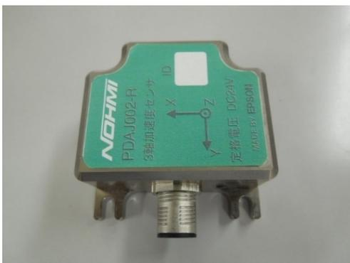
図 6.3.5 3軸加速度センサ
