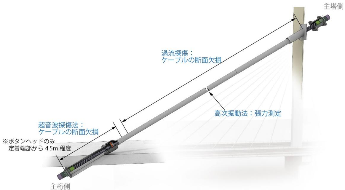
図 1.1.4 斜材システムに関する詳細調査の方法の例
