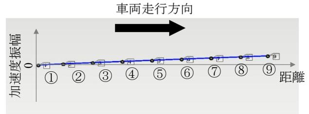
図 7.4.11 下り線の振動の理想形状(93Hz)
