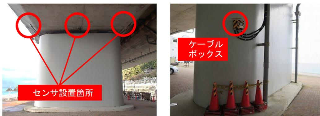
図 6.1.2 センサ・計測機器の設置箇所
