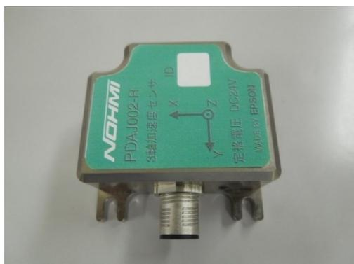
図 9.3.5 3 軸加速度センサ
