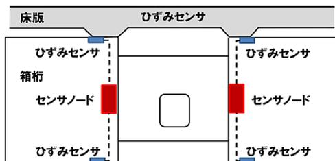
図 9.5.6 センサ設置状況 (C17)
