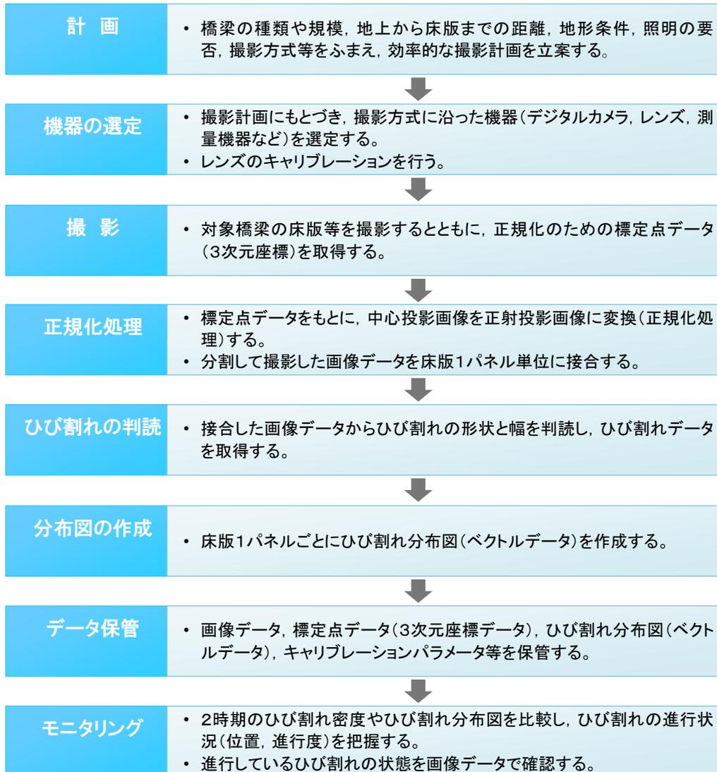
図 2.2.1 画像による床版のモニタリングの手順
