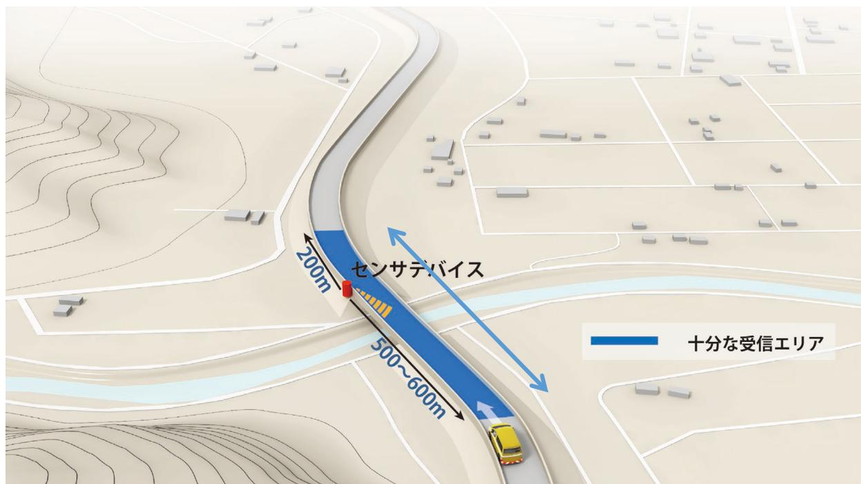
図 3.6.3 走行試験結果（下り走行車線/時速 80km）
