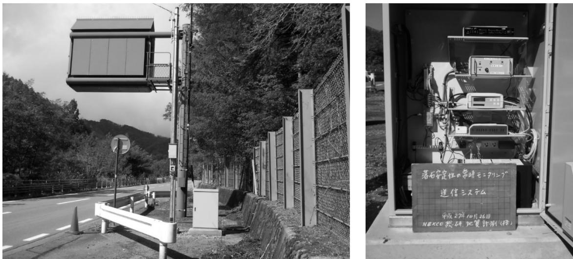
写真 7.1.4 送信システム全景と制御盤内部
