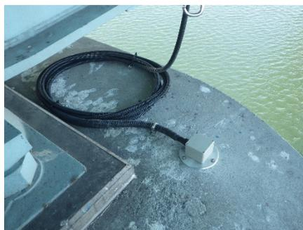
図 3.2.2 加速度センサの設置
