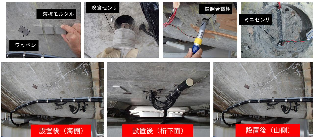
図 6.1.3 センサ・計測機器の設置状況
