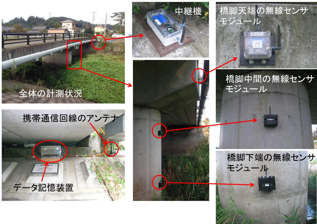
図 4.1.4 無線センサモジュールの取付け状況
