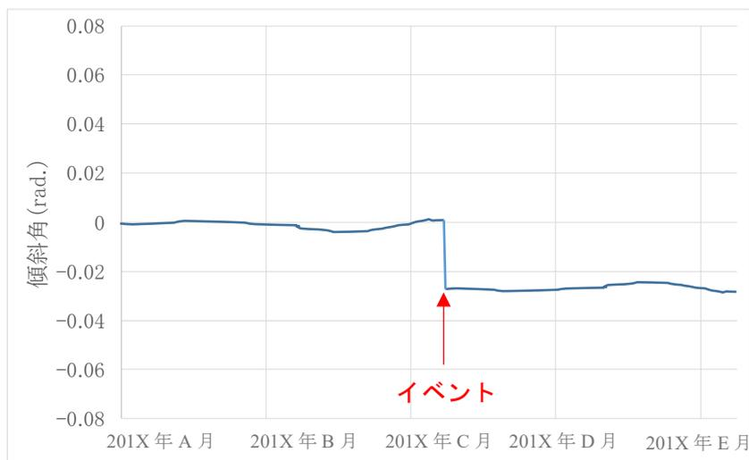
図 3.3.2 傾斜角のモニタリング結果のイメージ
