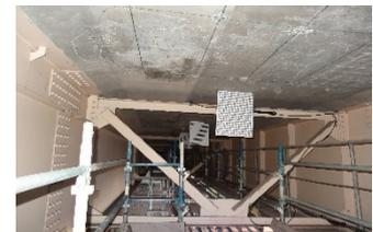
図 9.1.4 格子シート設置状況
