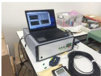
(付録)図 4 BOCDA 計測器の例
