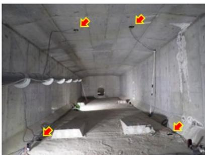
図 6.5.4 径間中点の加速度センサ設置状況
