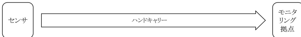
現場で測定したデータを即時にモニタリング拠点やデータセンタ等へ送る必要が無く、計測器等に内蔵されたメモリや、現場に設置したデータロガー等へ計測データを収録できる場合には、メモリ媒体を交換したり、センサをそのままモニタリング拠点まで運搬したりする事により、データを手持ちで運搬して回収する事ができる。なお記録媒体は破損しやすいため、運搬に当たっては、過度な衝撃・振動を与えず、また静電気・磁気などを避け、慎重に扱わなければならない。
