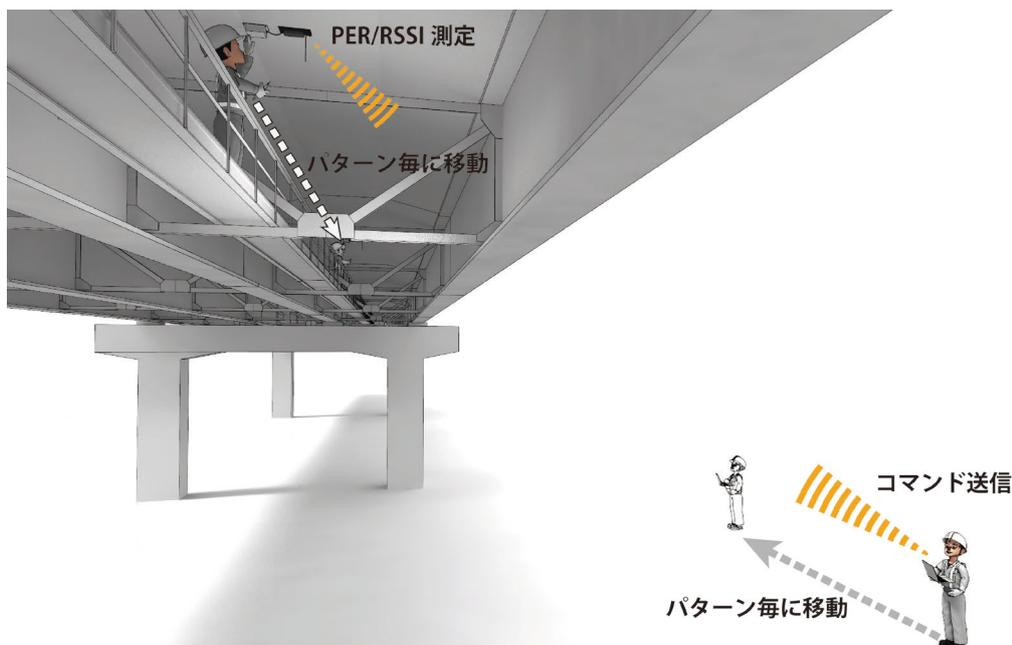
図 3.5.2 電波伝搬測定（検査路付近の様子）
