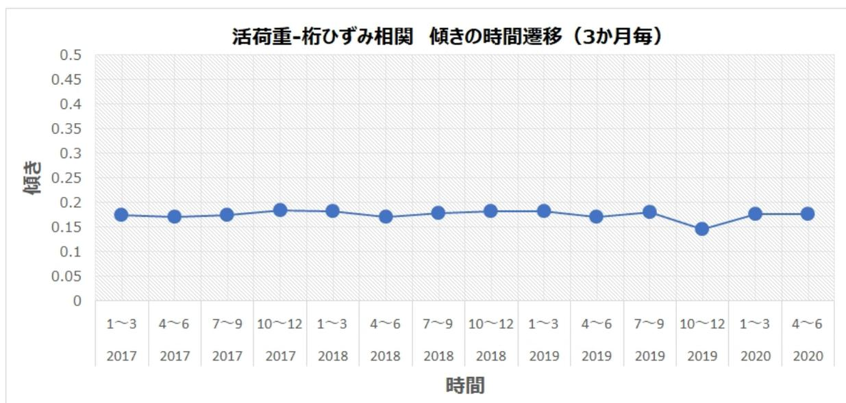
図 9.6.9 桁ひずみと活荷重の相関
