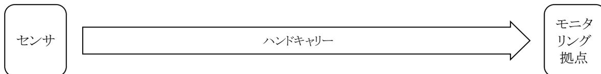
ひび割れモニタリングでは、インフラ現場へカメラ等の計測機器を持ち込んで作業員が計測するもので、現場にセンサは常設しないもしくは、計測時のみ電源供給、データ回収を行う。一般には、カメラに内蔵されたメモリへ撮影画像等のデータを格納し、これをカメラごと回収する。このため、3.2 節の「シナリオ(1) : データの手持ち回収」に相当する。
