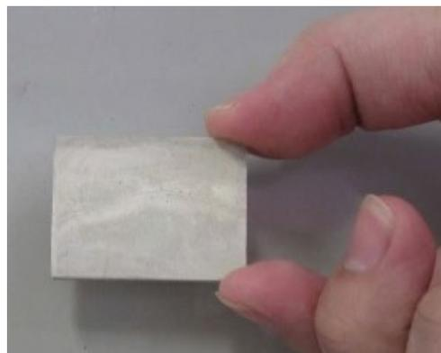
図 2.1.3 薄板モルタルの例
