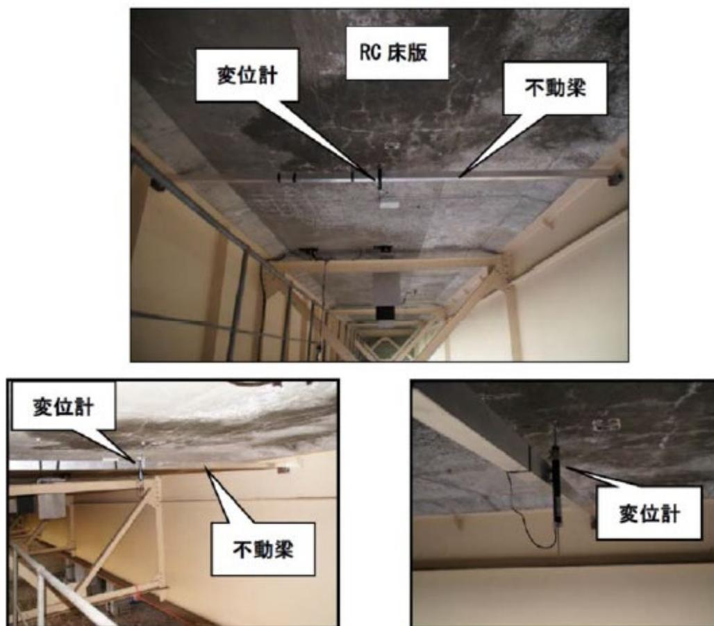
図 4.2.8 RC 床版の変位設置の概要
