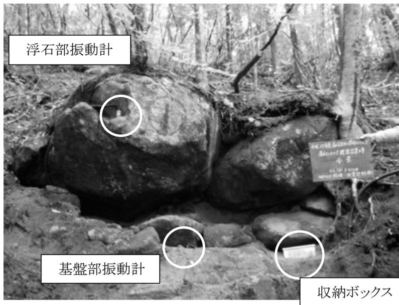
写真 7.1.1 機器設置全景
