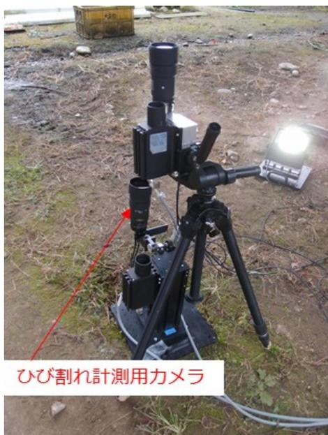
図 6.2.3 計測箇所および計測機器
