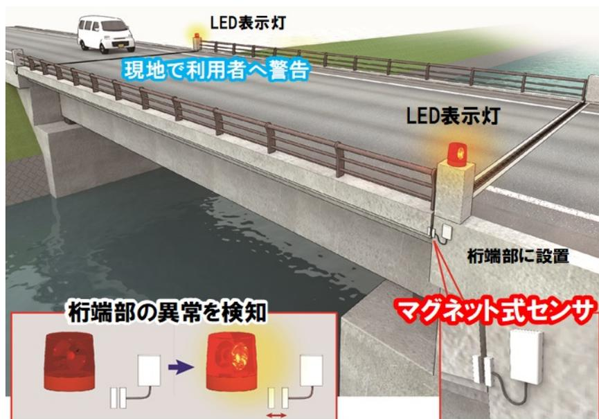
図 5.1.4 桁端部の異常検知モニタリングの例
