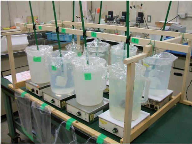
図-6 溶出試験装置
