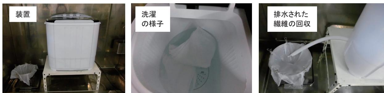
図-1 洗濯繊維の発生実験の装置概要
