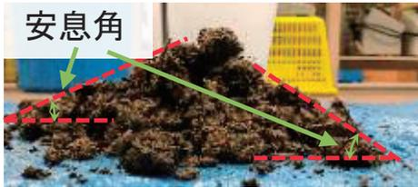
図-5 (a) 破砕機通過後し渣の安息角
