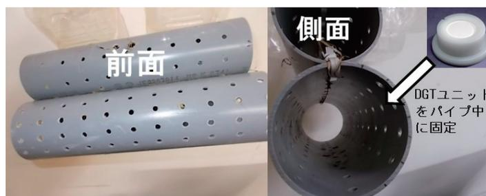
図-4 DGT ユニット取り付け用の観測機材
