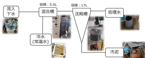
図-1 実験装置の概略フロー
