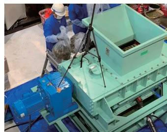
図-2 実験に供したし渣破碎機
