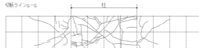
ひび割れベクトル図(F2, コンクリート, a_a断面)
