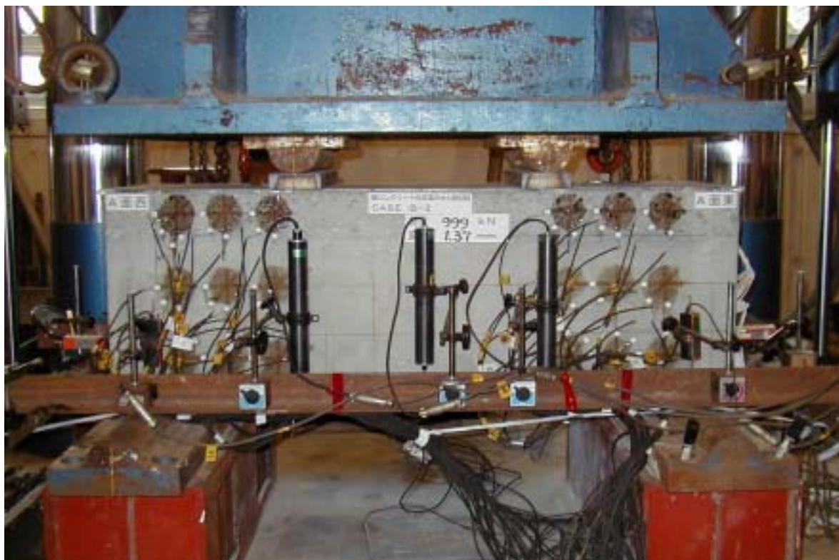
写真-3.2.2.1 5,000 k N 万能試験機 (土木研究所 岩石力学実験棟) を用いた載荷実験
