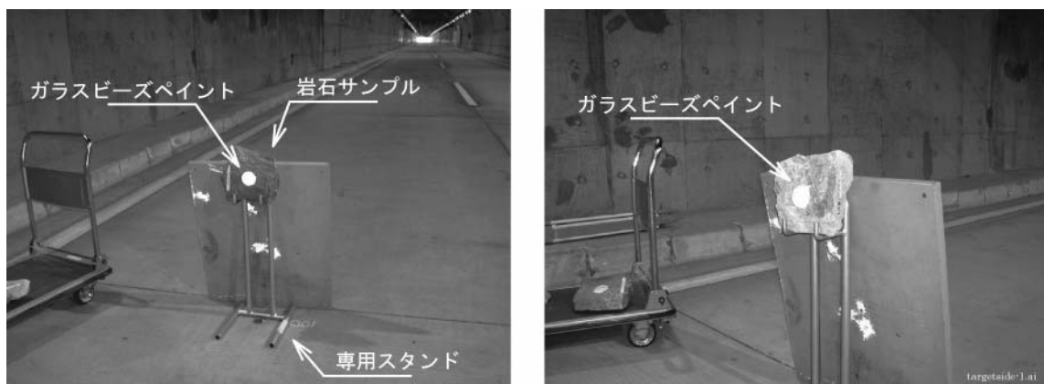
写真 3.5.4 計測対象のセッティング
