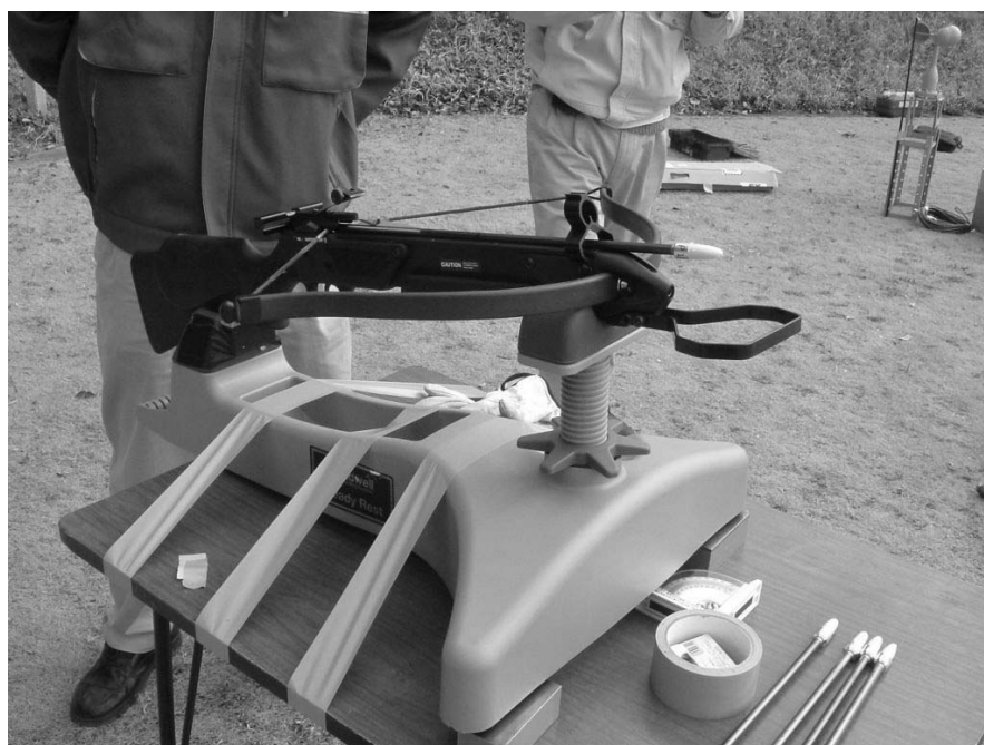
写真 5.1.5 設置治具とペイント入りカプセルを使用した矢
