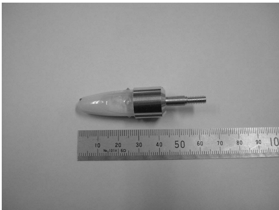
写真 4. 3. 2 ペイント入りカプセル・組立後
