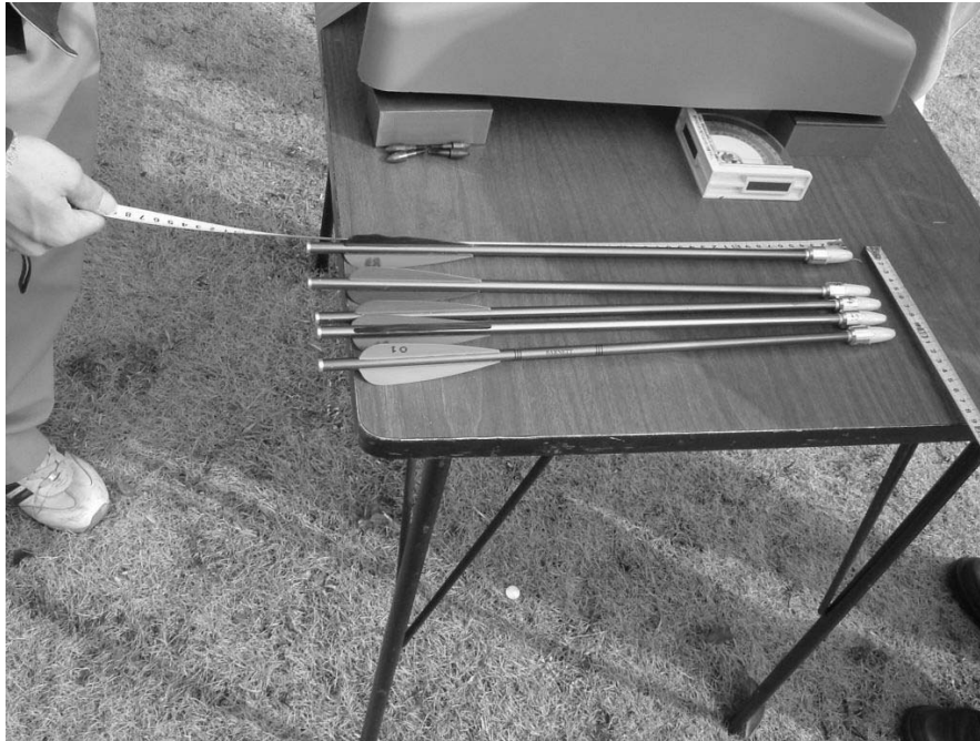
写真 5.1.4 ペイント入りカプセルを使用した矢
