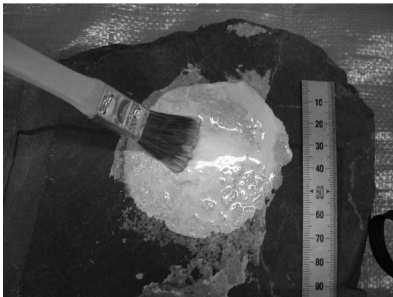
写真 4.4.1 塗布試験状況写真（試験片 No1：泥岩）
