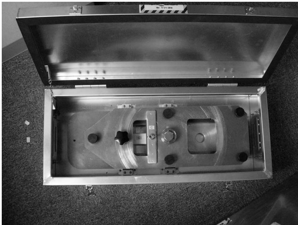
写真 5. 3. 7 設置架台下部の収納運搬容器（内部）
