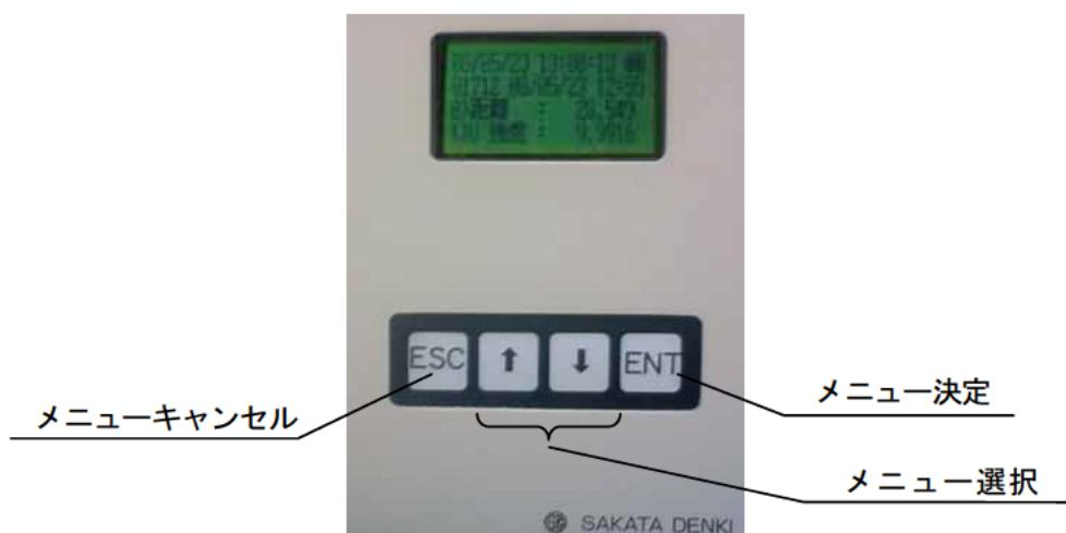
写真 4.5.11 測定器の操作キーと液晶画面
