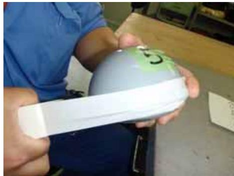
写真 4.6.16 センサ容器防水処理加工
