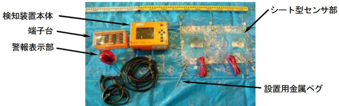
写真4.2.51 シート型センサシステム一式
