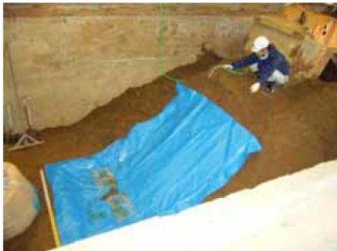
写真4.2.59 湧き水実験注水開始状況
