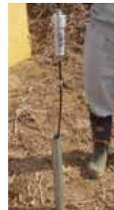
写真 4.1.11 単管打設型設置状況
