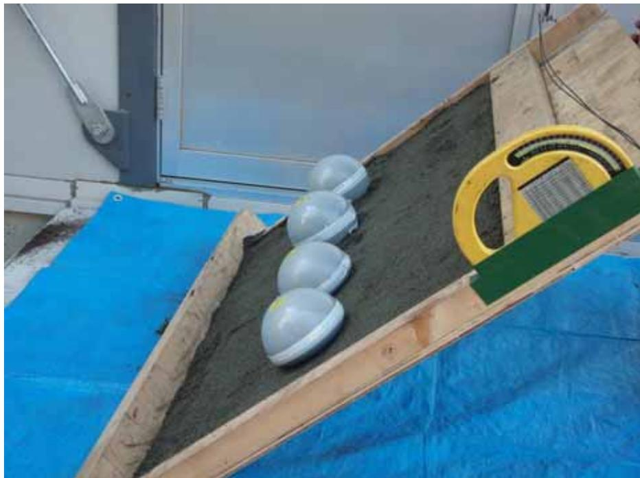
写真 4.6.19 転倒実験(1) 状況(センサ傾斜状態)
