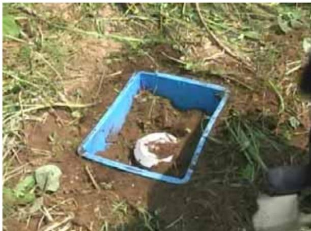
写真 4.5.9 図 4.5.7 中 の位置 変位センサ周囲が土の条件（覆土を模擬）
