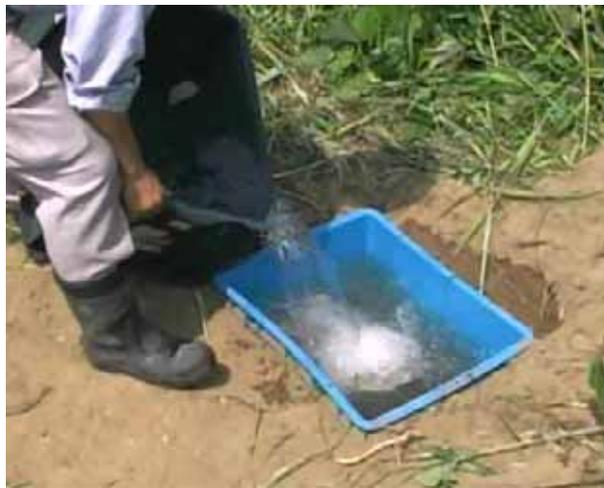
写真 4.5.8 図 4.5.7 中 の位置 変位センサ周囲が水の条件（冠水を模擬）
