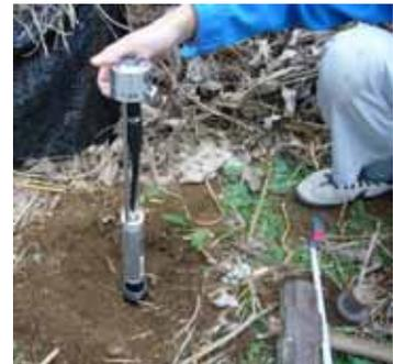
写真 4.1.18 単管打設型深入設置タイプ設置状況
