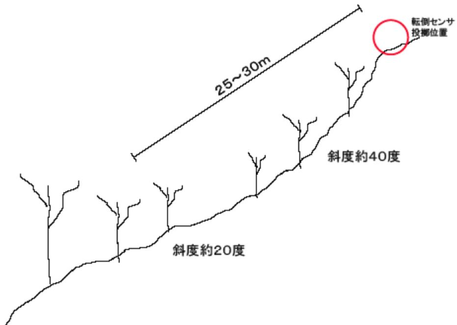
図 4. 6. 3 投げ込み実験地斜面のイメージ図
