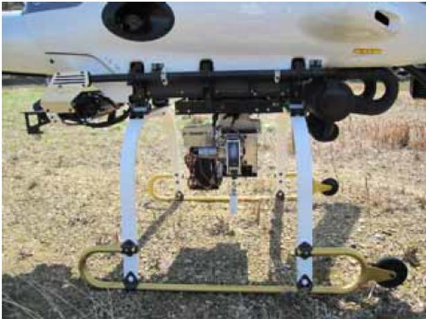
写真 4.3.30 ラジコンヘリに取付けた投下装置
