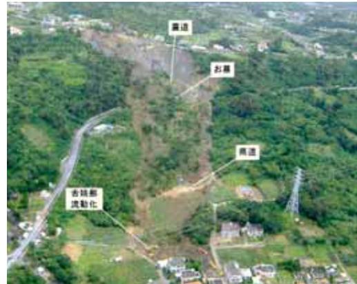
写真 3.1.2 沖縄泥岩地すべりタイプ（北上原地区）<sup>3)</sup>
