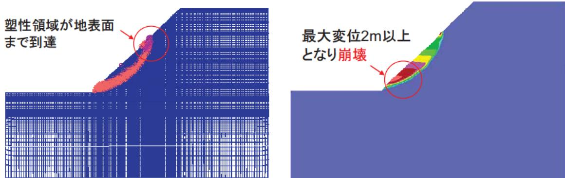
図 4.58 Case⑦ 自重解析後の塑性分布図（左）と水平変位分布図（右）
