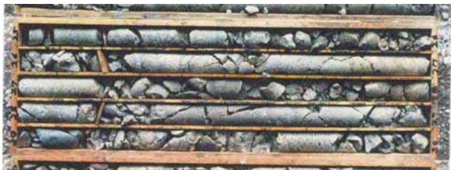
写真5.1 破碎されている凝灰岩(D級)
