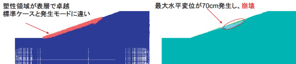
図 4.56 Case⑤ 自重解析後の塑性分布図（左）と水平変位分布図（右）
