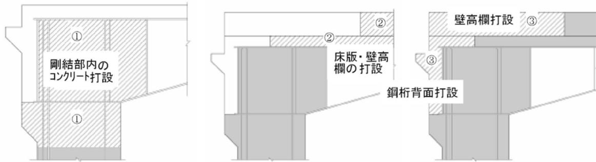
図 3.2.2 上・下部構造接合部の分割施工例
