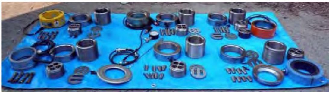
写真 10.39 荷重計取外し後の緊張治具
