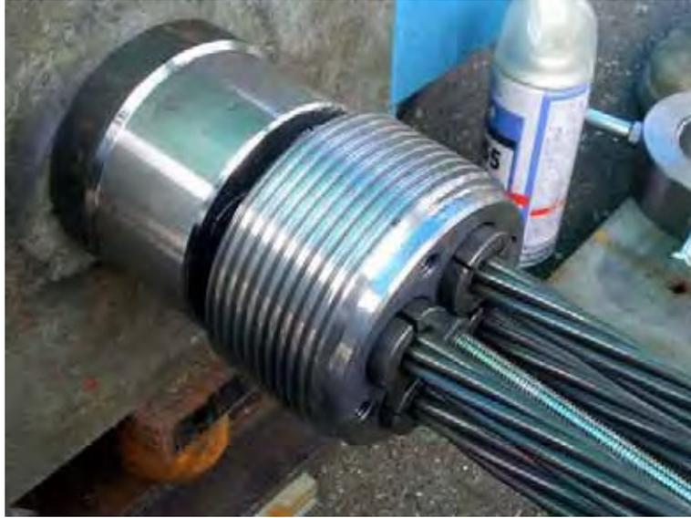
写真 11.18 ゆるくセットのくさび状態
