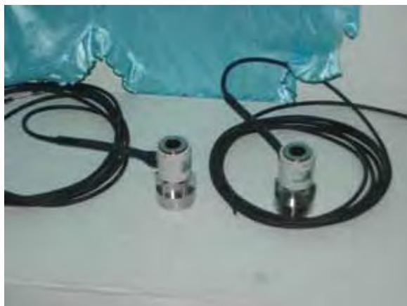
写真 11.11 斜材張力管理用荷重計（ひずみゲージ式荷重計）
