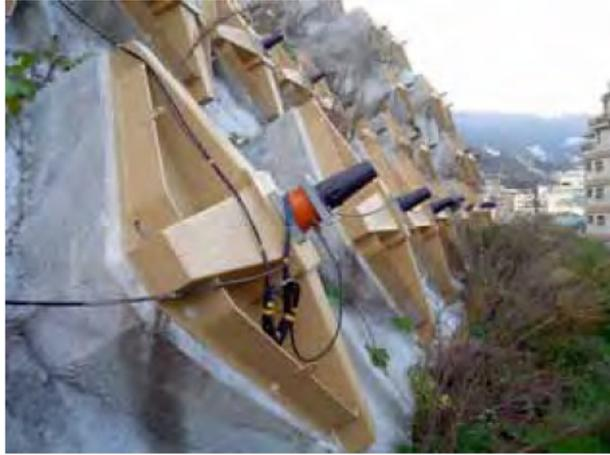
写真 1.3 荷重計の設置例
