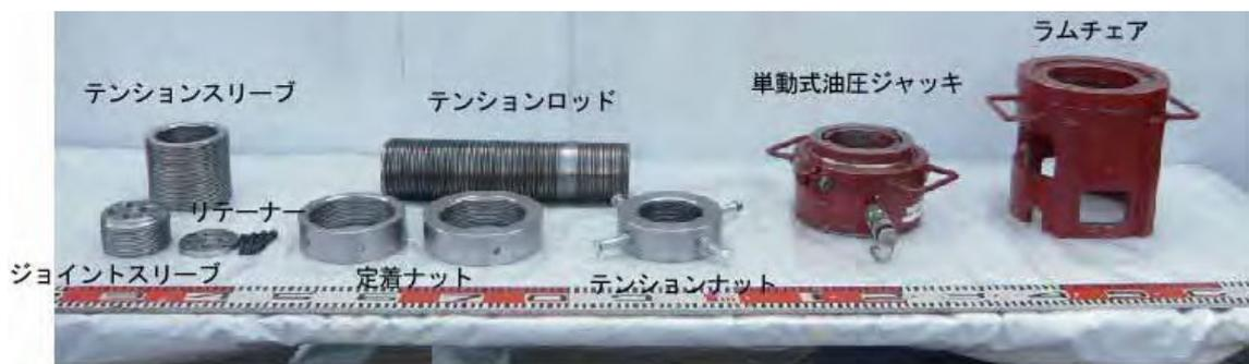
写真 4.2 緊張治具一式（単動式油圧ジャッキ）
