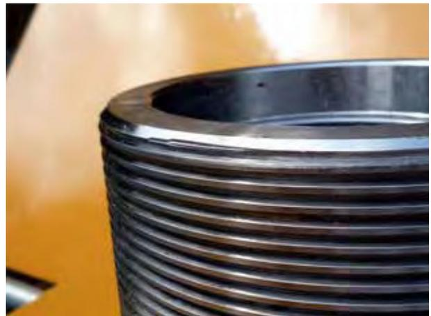
写真 10.78 テンションスリーブ ネジ部の変形
