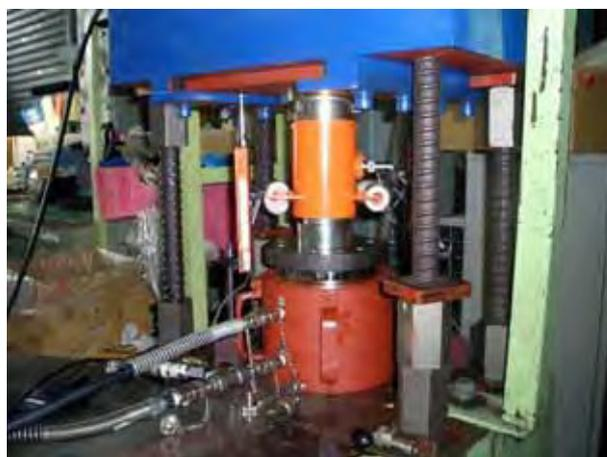
写真 7.2 ジャッキ校正試験状況
