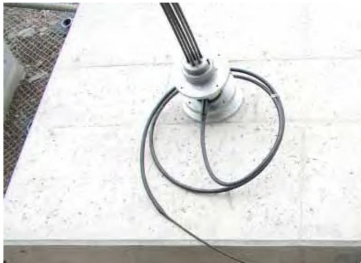
写真 11.13 地すべり対策工事におけるグラウンドアンカーの軸力測定実施状況
