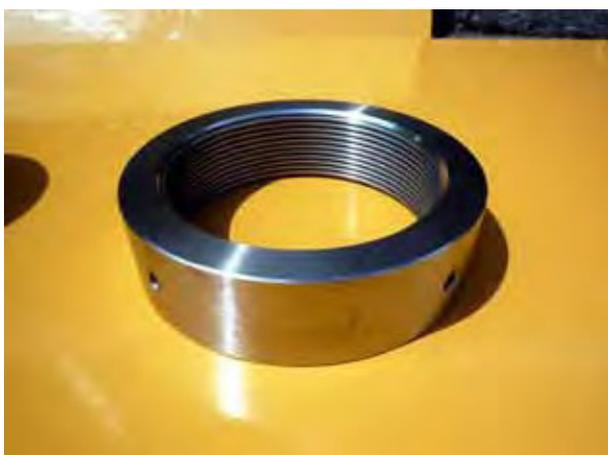
写真 10.79 定着ナットの側面
