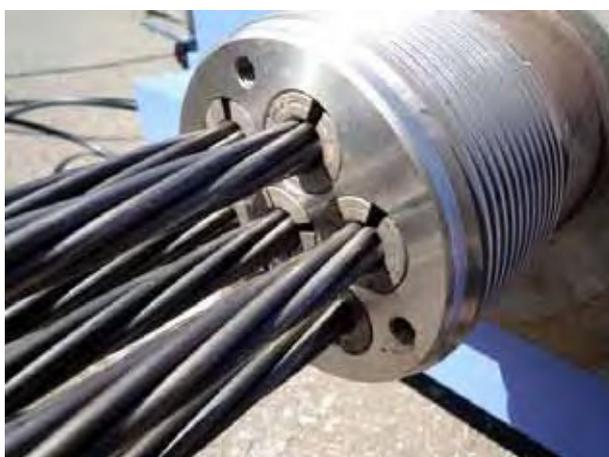
写真 11.24 ジョイントスリーブのくさび
