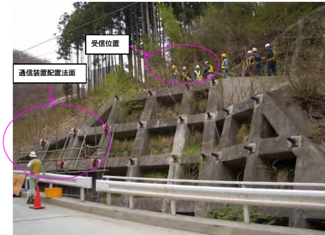
写真 10.99 アンカー直上通信試験状況
