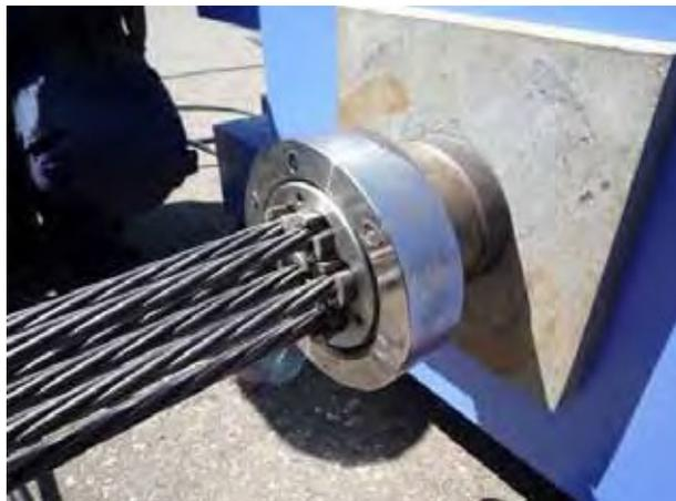
写真 11.30 取外し後のくさび状況
