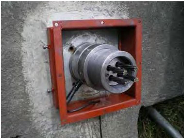
写真 10.16 荷重計取付け状況
