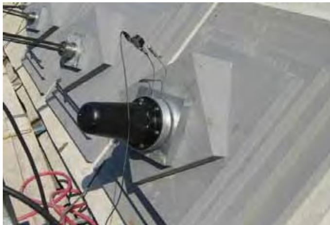
写真 11.15 ダム側面のグラウンドアンカー軸力測定実施状況 2
