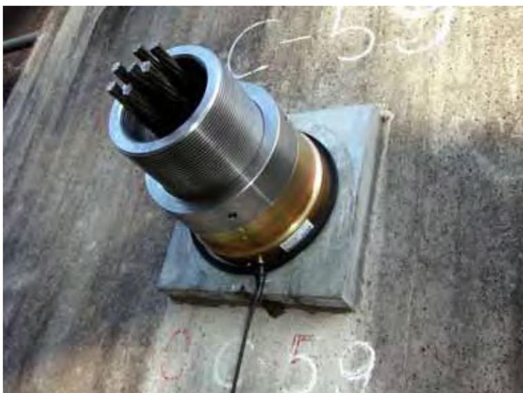
写真 10.63 荷重計取付け状況
