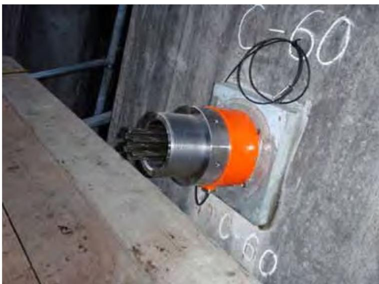
写真 10.64 荷重計取付け状況
