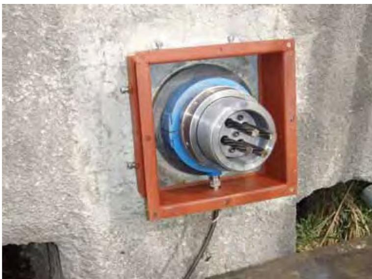
写真 10.18 荷重計取付け状況
