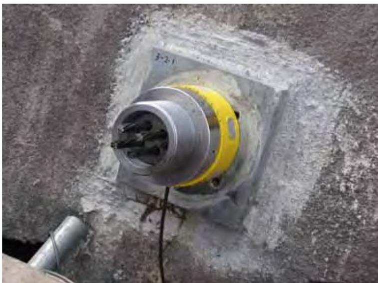
写真 10.13 荷重計取付け状況
