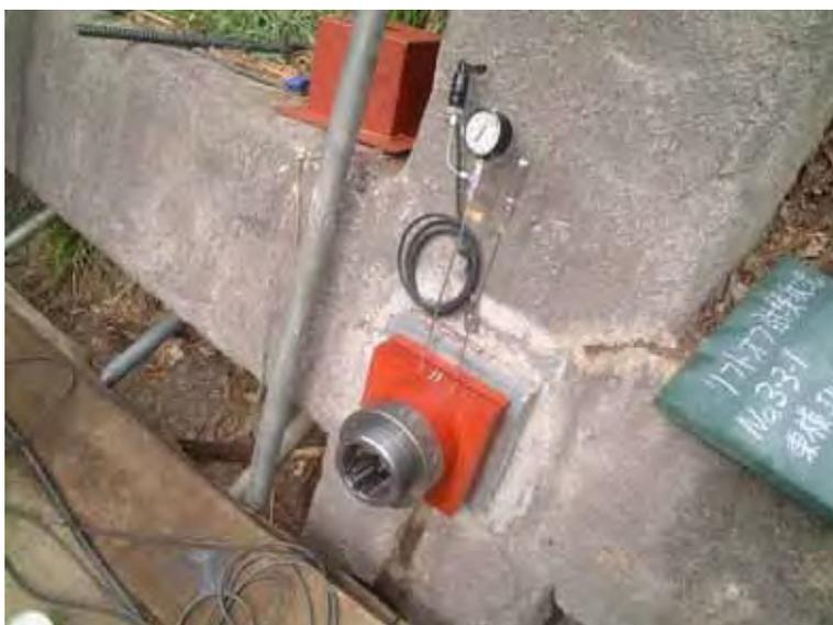
写真 10.17 荷重計取付け状況
