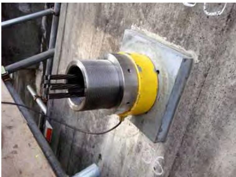
写真 10.60 荷重計取付け状況
