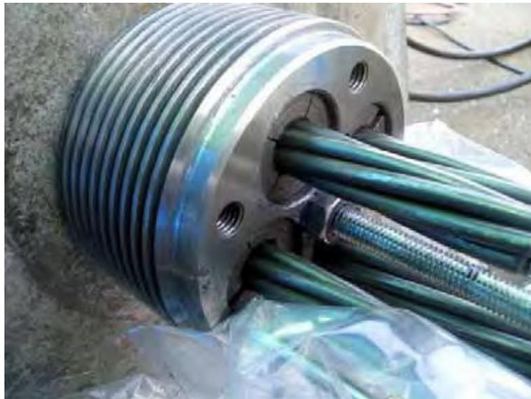
写真 11.20 最大載荷時のくさび状態
