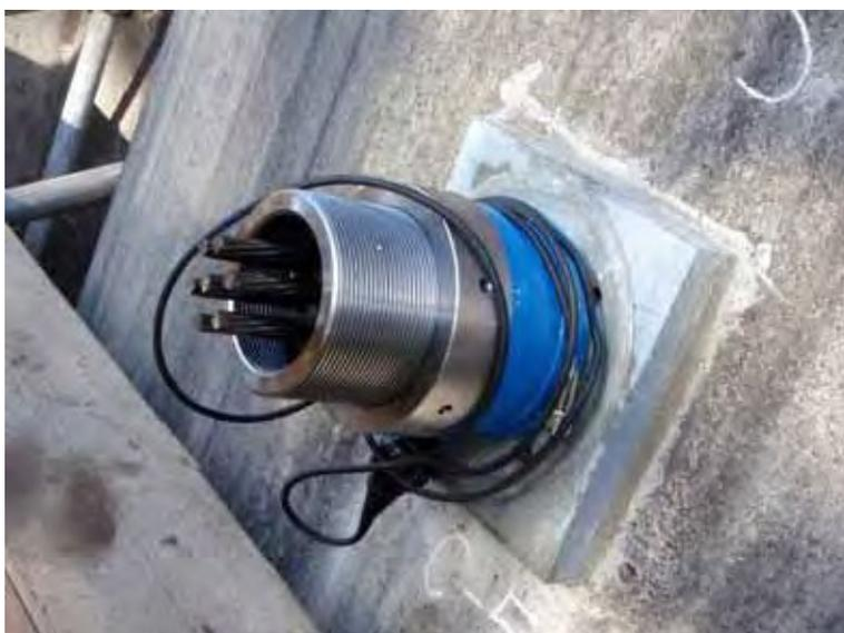
写真 10.61 荷重計取付け状況
