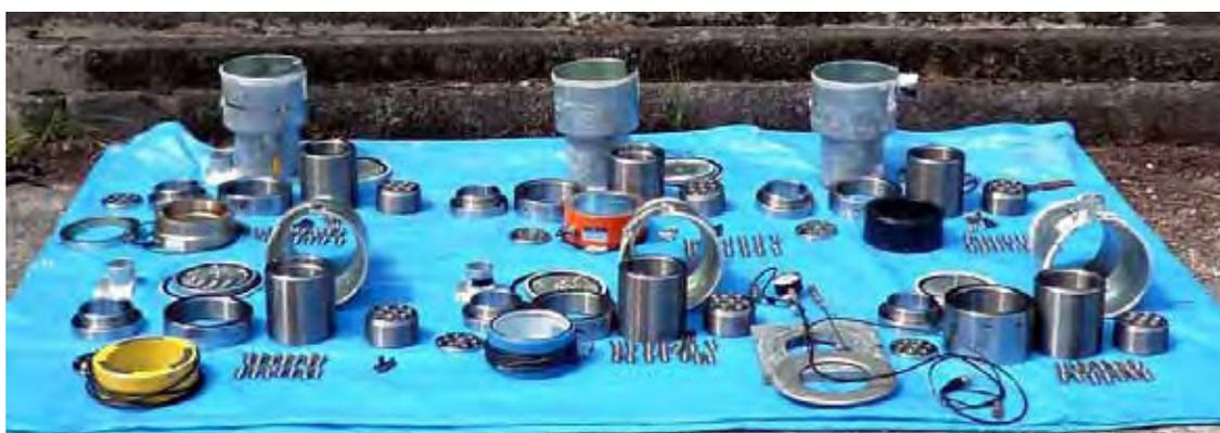
写真 10.74 荷重計取外し後の緊張治具
