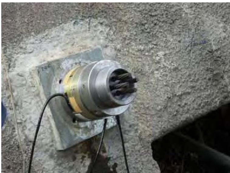
写真 10.14 荷重計取付け状況
