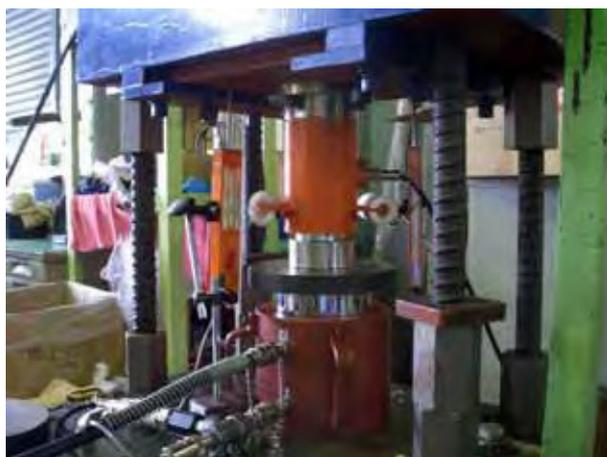
写真 4.4 ジャッキ校正試験状況（複動式ジャッキ）
