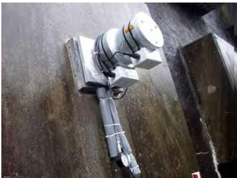
写真 10.62 荷重計取付け状況
