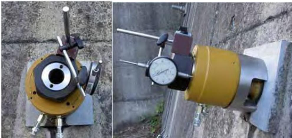
写真 11.8 軽量ジャッキのセット状況
