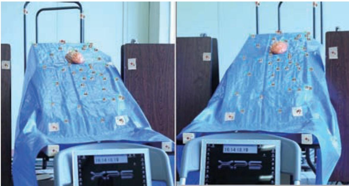
図 4.6 任意対応点の追加状況(誤対応点削除後)
