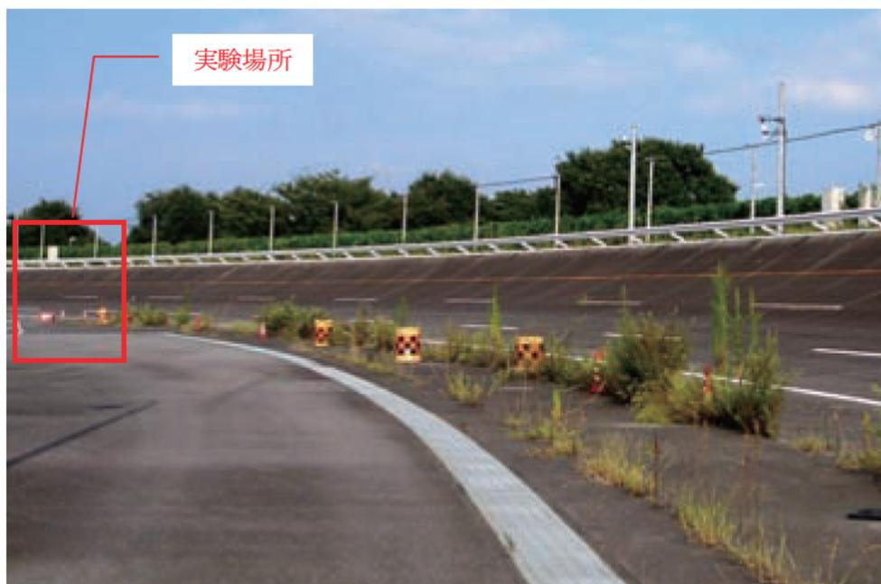
写真 3.12 斜面を模擬したバンク
