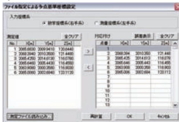
図 3.78 基準座標設定状況（最低3点以上必要）
