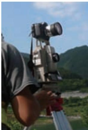
写真 3.3 カメラの設置状況
