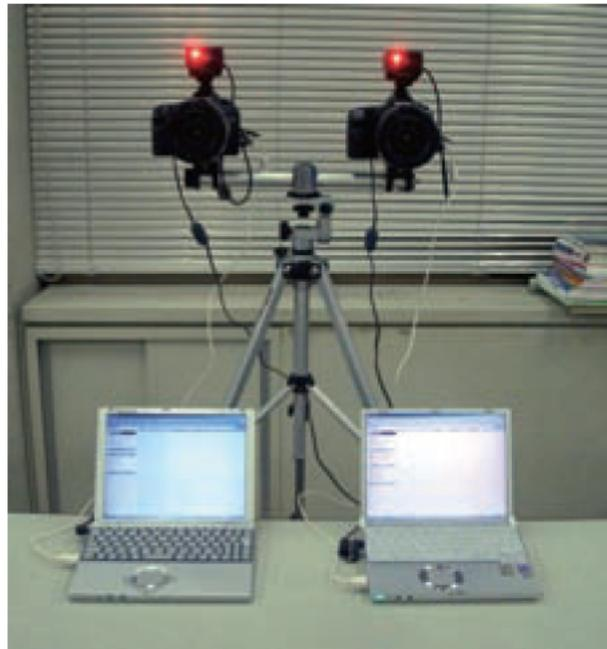
写真 2.3.3 連写性能検証時のシステム構成 (PC 保存のケース)
