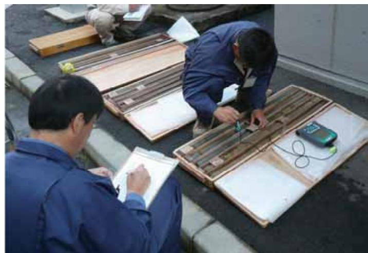
写真4.12 エコーチップ反発硬度計測状況
