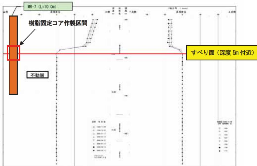
図 3.6.4 M7 孔内傾斜計観測結果図 (1999 年 11 月～2000 年 11 月)<sup>2)</sup>
