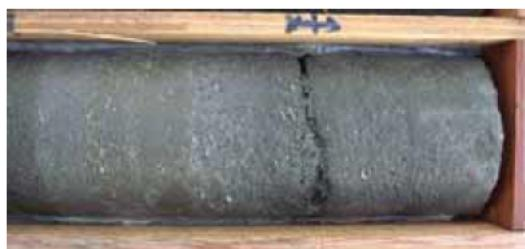
写真 4.7 深度 29.9m 付近の粗粒砂岩(白い斑点状の部分が貝殻片)
