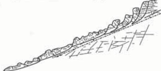
(2)-a. すべり面強度、既往すべり面の残留強度、破碎泥岩のピーク強度、断層鏡肌の残留強度が動員される。
