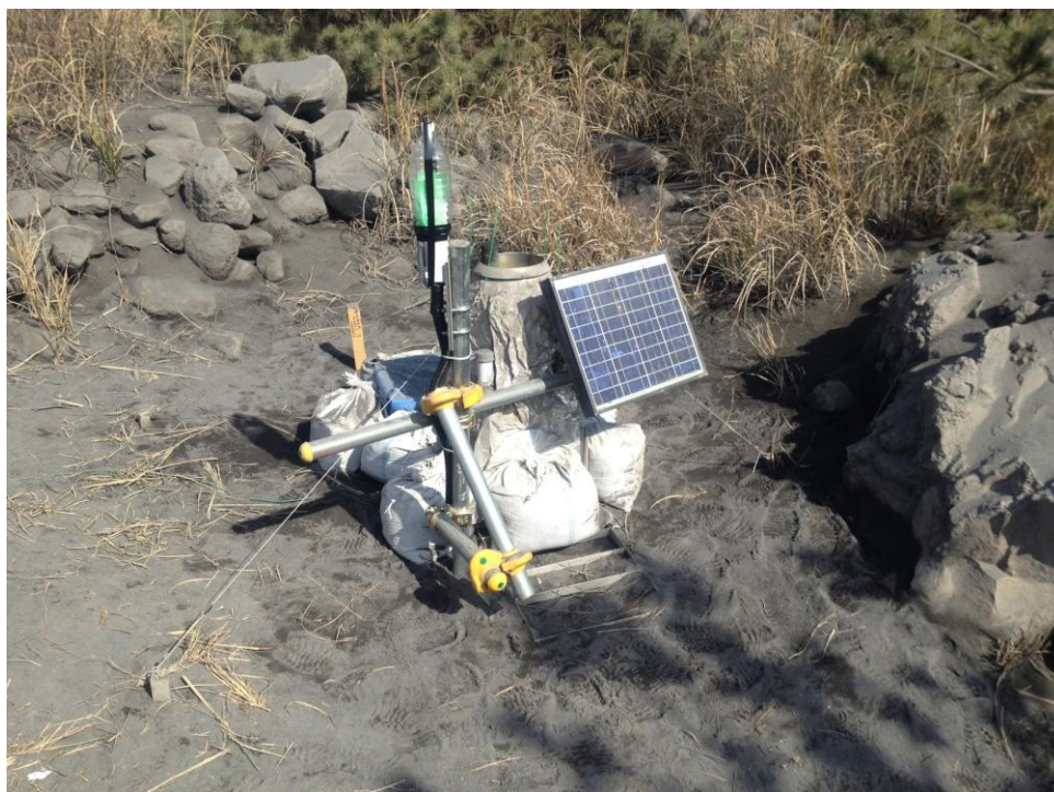
図 10 超小型通信端末設置状況
