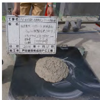
写真-4 フレッシュコンクリート性状の経時変化
