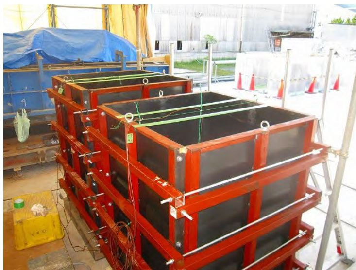
写真-6 試験に用いた鋼製型枠（1m 角）
