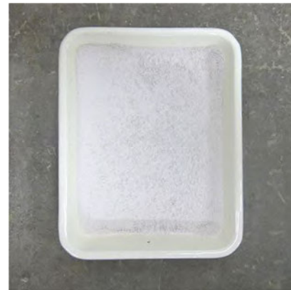
高炉スラグ微粉末 4000 (無水せっこうを三酸化硫黄( \text{SO}_3 ) 換算で 2.0%内添)
