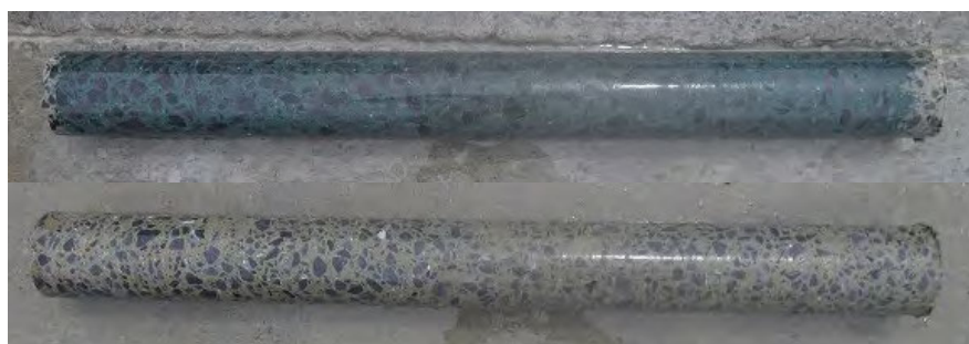
写真-6 1m 角ブロックから採取したコア供試体 \phi 100\text{mm} \times 1,000\text{mm} 長 (撮影: 材齢 28 日目)
