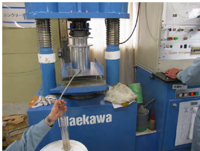
写真-7 加圧ブリーディング試験状況
