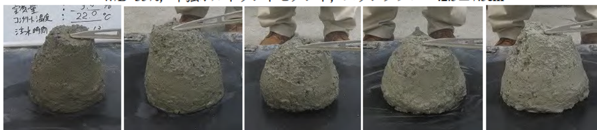
写真-2 スランプフロー試験時におけるフレッシュコンクリートの表面色調
