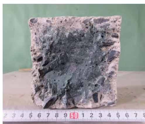
(B) 高炉スラグ微粉末の置換率を90%としたコンクリート (W/B=35%)
