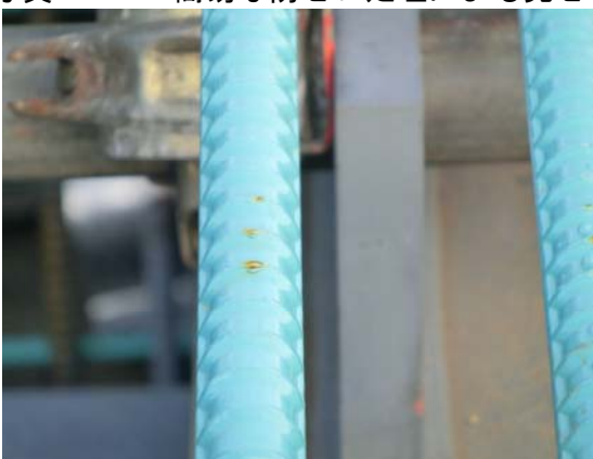
写真 6.1.3 エポキシ樹脂塗装鉄筋の傷と発せい
