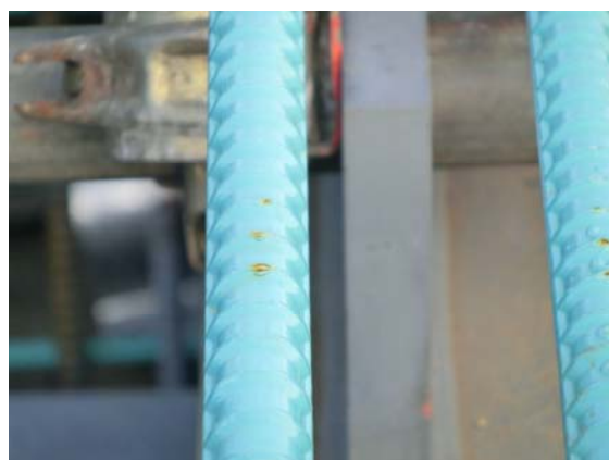
写真 3.4.7 エポキシ樹脂塗装鉄筋の傷と発せい
