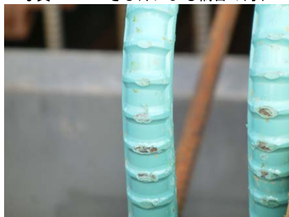
写真 6.1.3 エポキシ樹脂塗装鉄筋の傷と発せい
