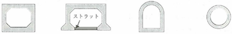
1) ボックスカルバート 2) 門形カルバート 3) アーチカルバート 4) パイプカルバート
