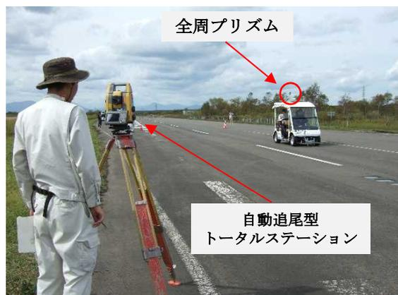
図-2.3 TSによる計測状況
