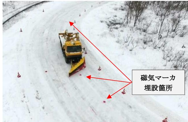
図-2.8 自車位置推定試験 (曲線部)
