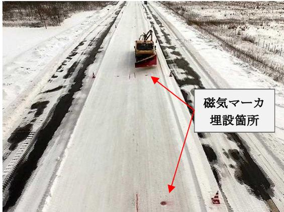
図-2.7 自車位置推定試験 (直線部)
