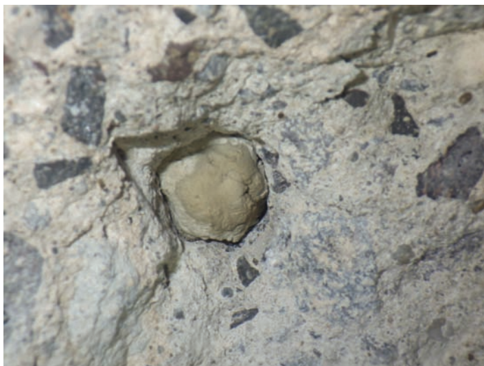
(b) 写真(a)のポップアウトの核となった異物
