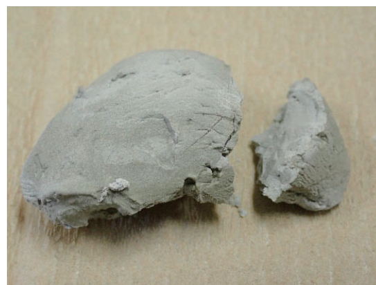
図-A2.2 採取試料 (分割して右側を分析に使用)
