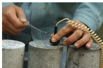
写真2 円柱供試体での弾性波速度測定状況
