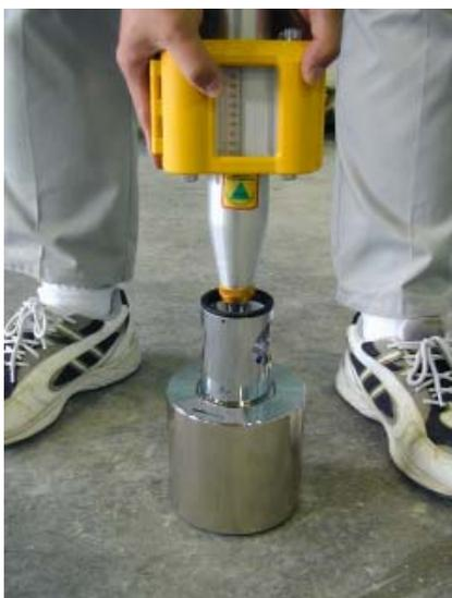
テストアンビルは、反発度の再現性を重視した大型のものから、携帯性に優れた小型・軽量のものまで様々な種類のものがあります。使用する際は、そのテストアンビルの反発度を確認してください。
