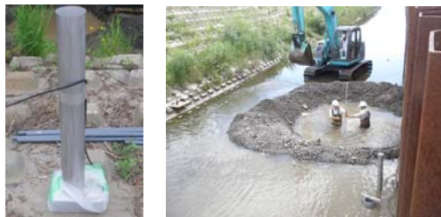
写真-1 製作したロードセル採砂器(左)と実験水路での埋設状況(右)
