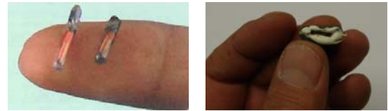
写真-2 使用した IC タグ (左) と作製した掃流砂 (右)
