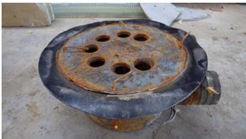
図-23 実験後の吸引部の吸着防止材の破損状況
