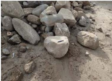
図-4 堆砂中の巨石の状況 (石の上に 15cm のペンを配置)
