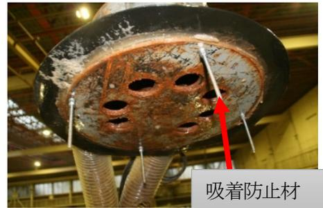
図-12 潜行吸引式排砂管の吸引形状の改造
