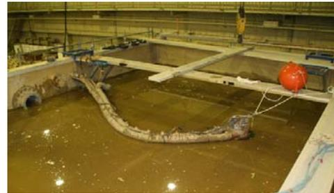
図-13 吸引部への浮きの設置状況
