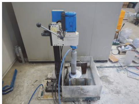
写真-2 コア削孔状況
